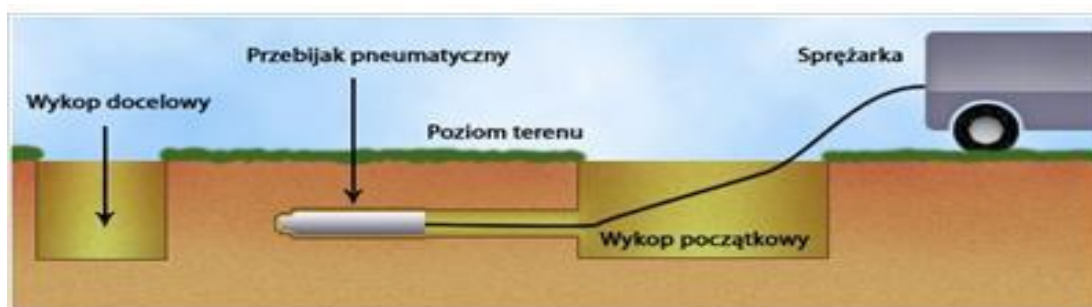
Rys. 1. Budowa rurociągu metodą przecisku pneumatycznego przebijakiem, tzw. kretem
