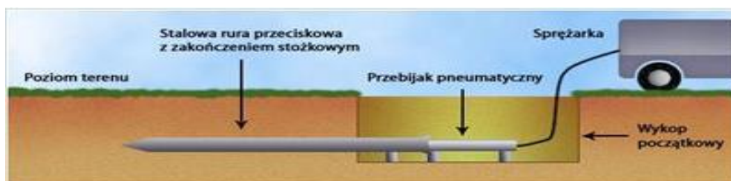
Rys. 3. Budowa rurociągu metodą wbijania rur stalowych zamkniętych od czoła
