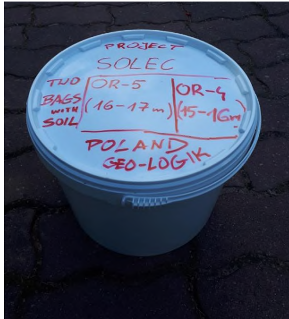
Ryc. 55. Szczelny pojemnik zawierający zapakowane odrębnie próbki gruntu ze spągowych stref dwóch otworów wykonanych w X 2018 w Solcu Kujawskim.
