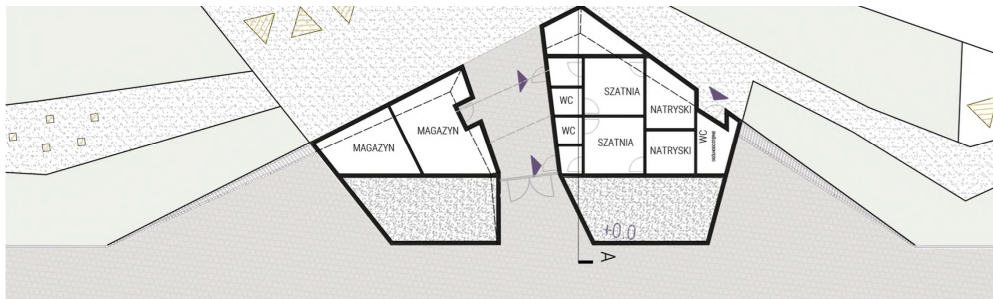
PRZEKRÓJ PRZEZ PAWILON, BIEŻNIĘ I BOISKO, SKALA 1:250
