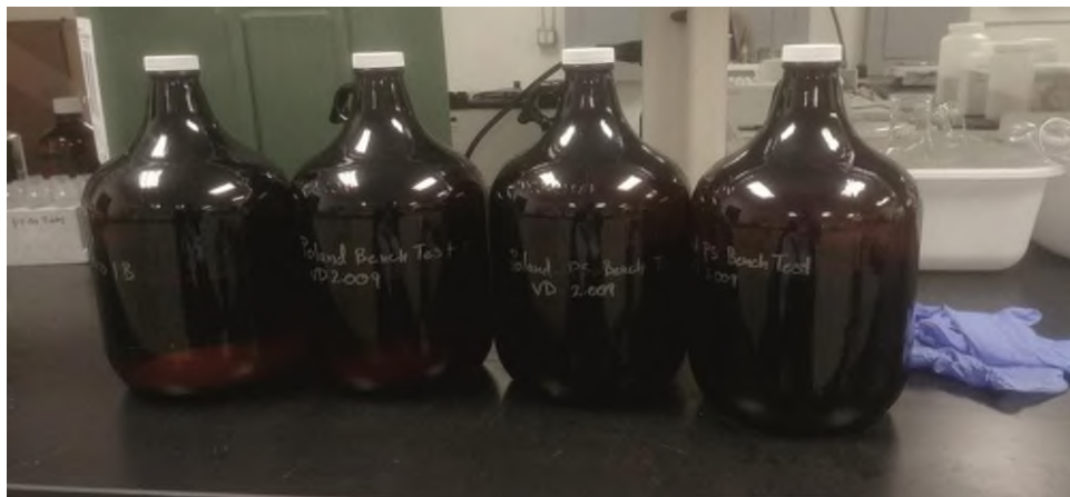
Ryc. 56. Zbiorniki reakcyjne do testów w laboratorium REGENESIS w San Clemente w USA zawierające zanieczyszczony materiał z Solca Kujawskiego
