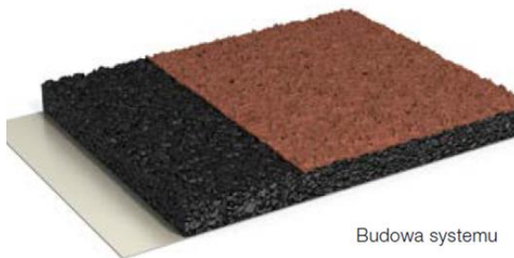
Zdj. Nawierzchnia poliuretanowa typu "natrysk" - zdjęcie poglądowe
