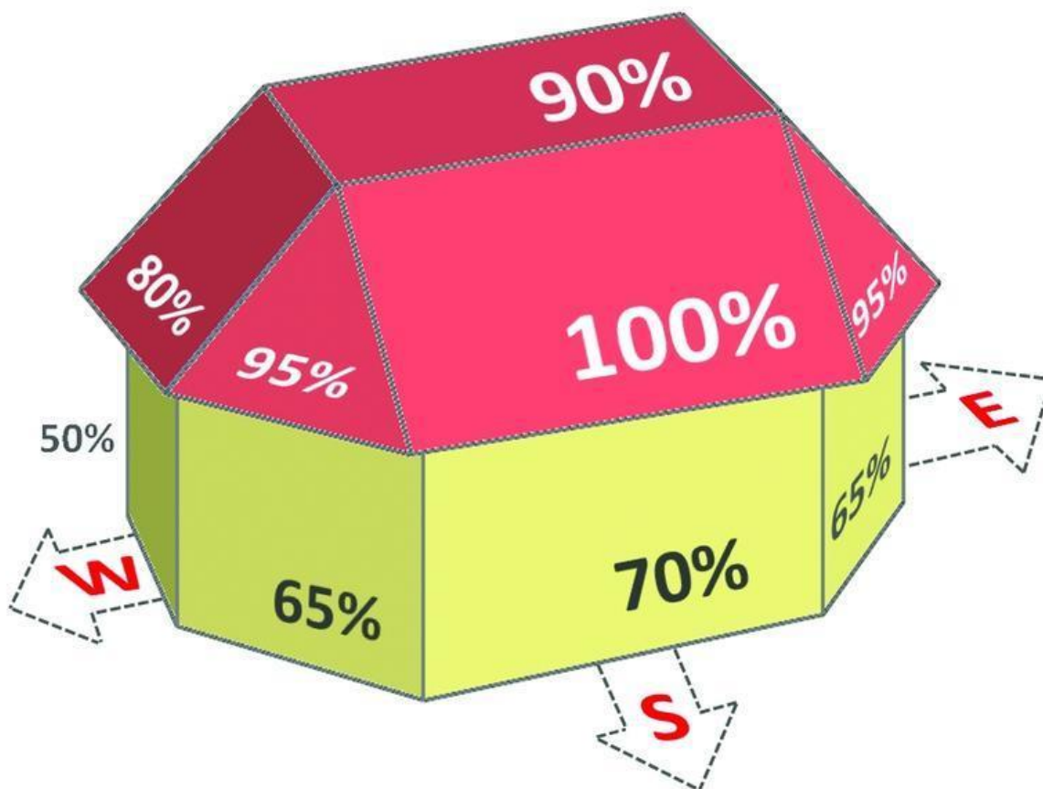
Rysunek 14 Zmniejszenie ilości energii promieniowania słonecznego w czasie roku dla warunków innych niż optymalne (skierowanie na południe \pm 45^\circ oraz nachylenie 25\text{--}45^\circ ) Fot.: Hewalex
