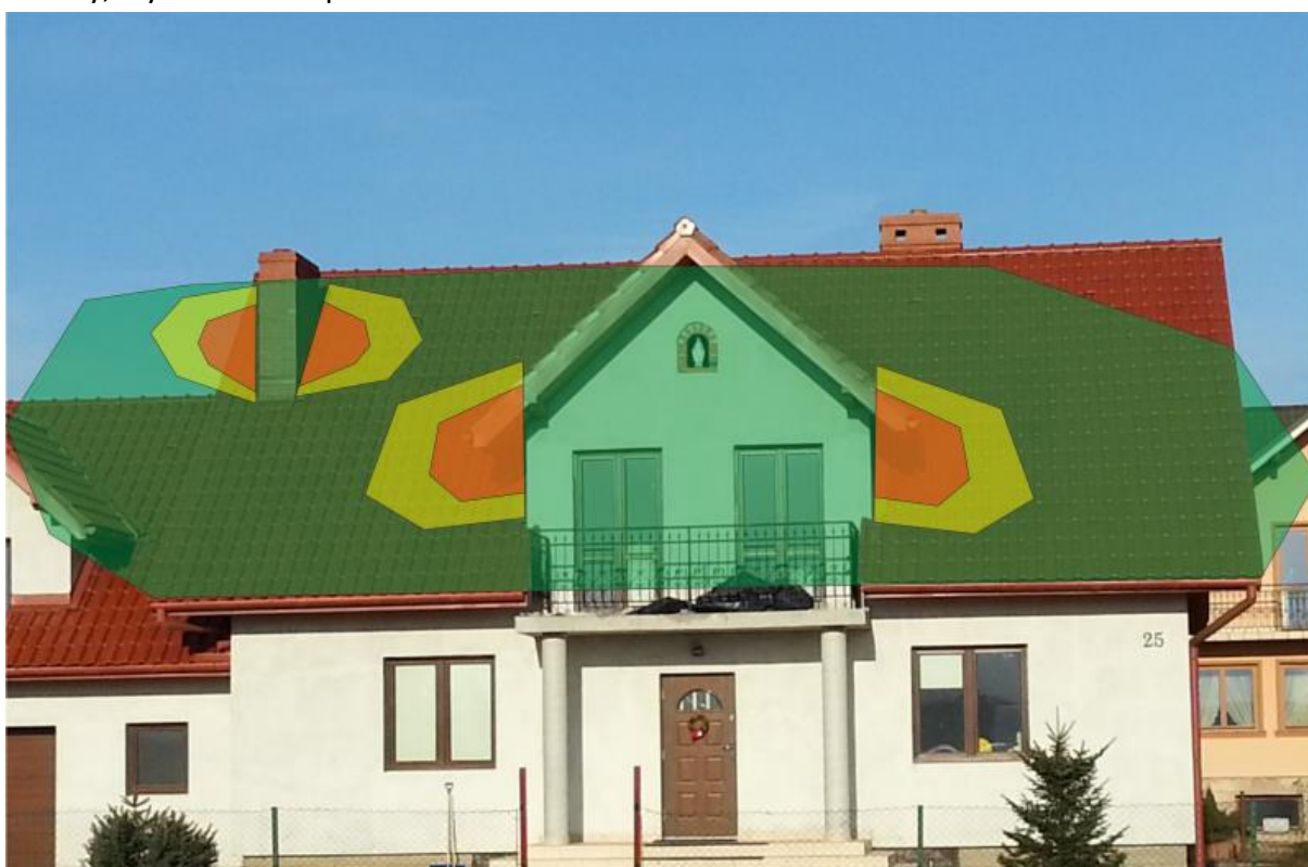
Rysunek 5 Strefy zacienienia na dachu skierowanym na południe
