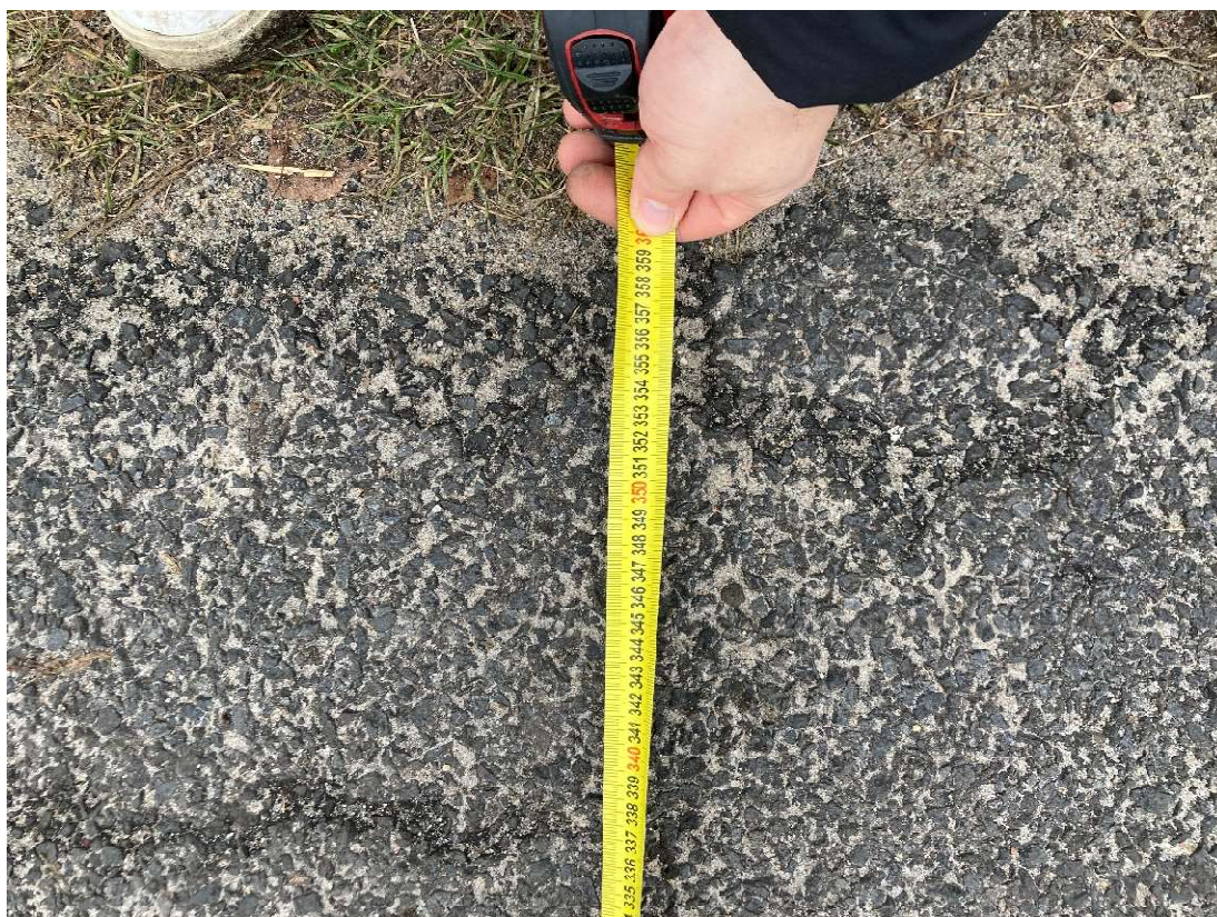
Fot. 6. Przykładowy pomiar szerokości istniejącej nawierzchni drogi
