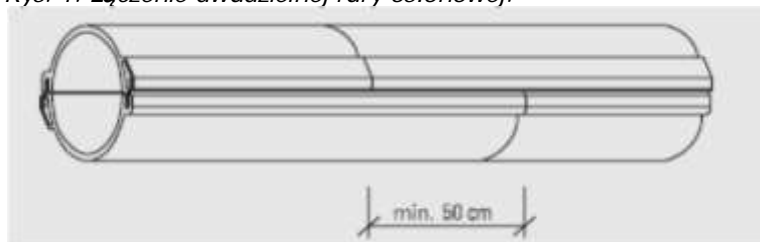
Rys. 1. Łączenie dwudzielnej rury osłonowej.
