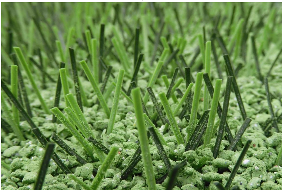
Fig. 5: DOMO Duraforce XSL po 20.000 cyklach na testerze zużycia Lisport
