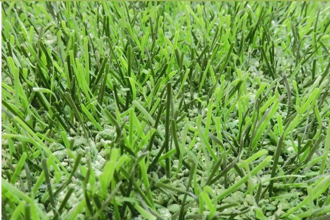
Fig. 28: DOMO Duraforce XSL po 260.000 cyklach na testerze zużycia Lisport
