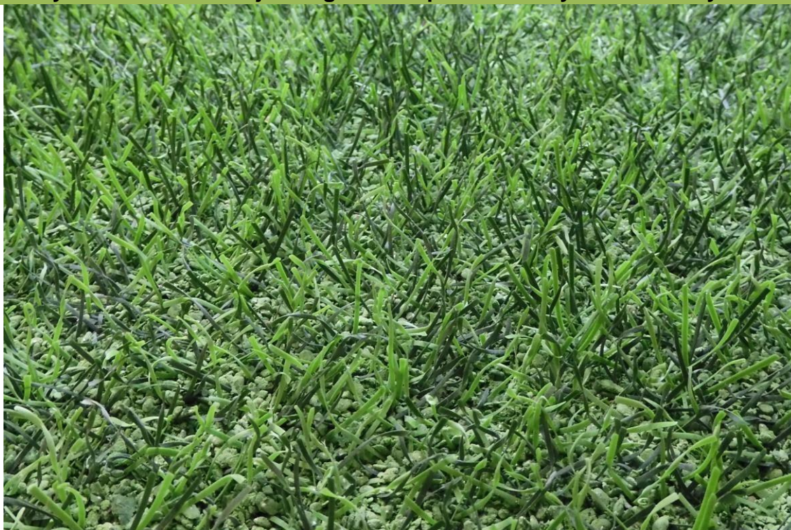
Fig. 30: DOMO Duraforce XSL po 280.000 cyklach na testerze zużycia Lisport
