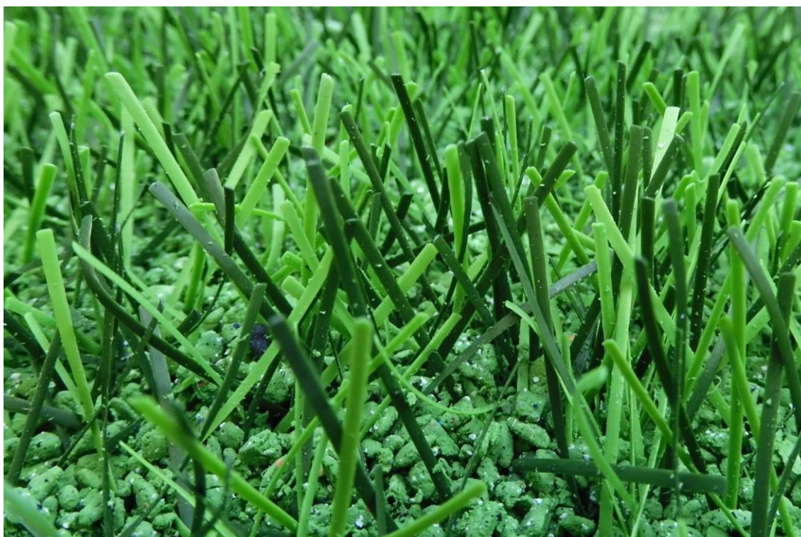
Fig. 17: DOMO Duraforce XSL po 140.000 cyklach na testerze zużycia Lisport
