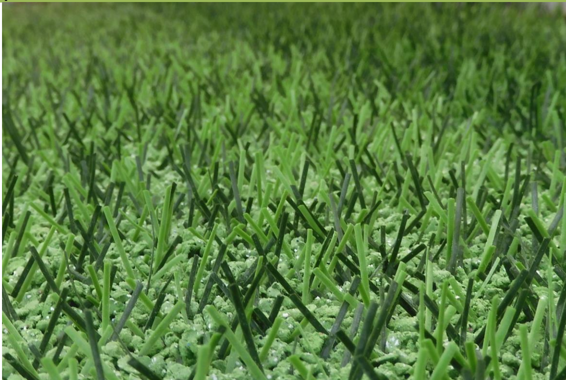
Fig. 6: DOMO Duraforce XSL po 40.000 cyklach w testerze zużycia Lisport
