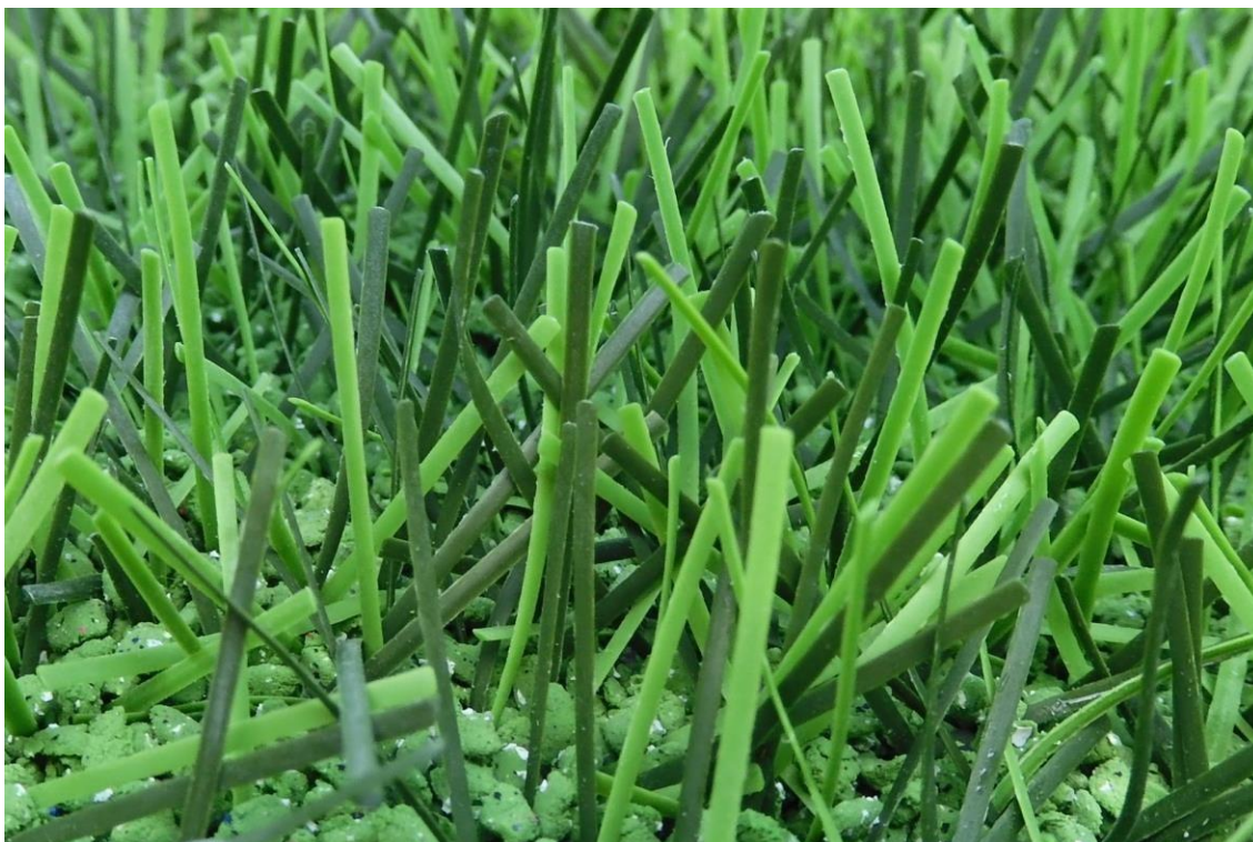
Fig. 13: DOMO Duraforce XSL po 100.000 cyklach na testerze zużycia Lisport
