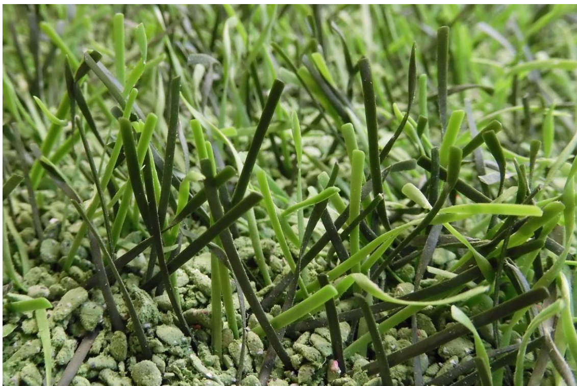
Fig. 31: DOMO Duraforce XSL po 280.000 cyklach na testerze zużycia Lisport
