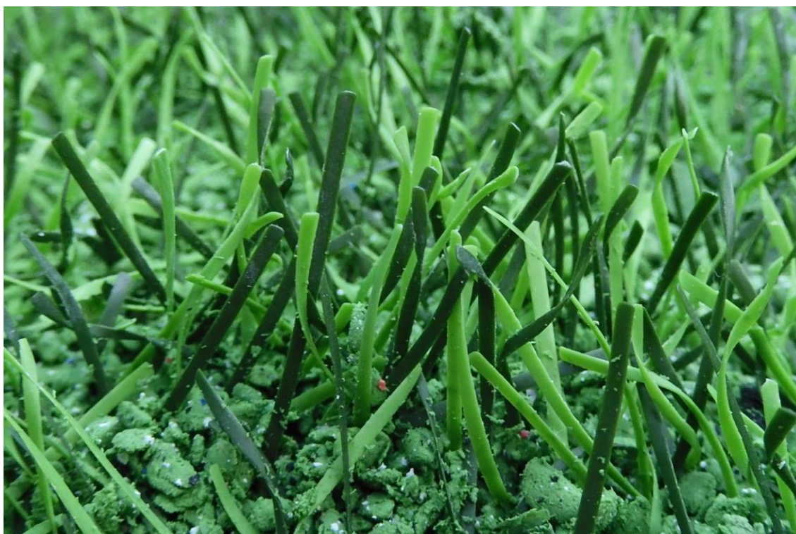
Fig. 25: DOMO Duraforce XSL po 220.000 cyklach na testerze zużycia Lisport
