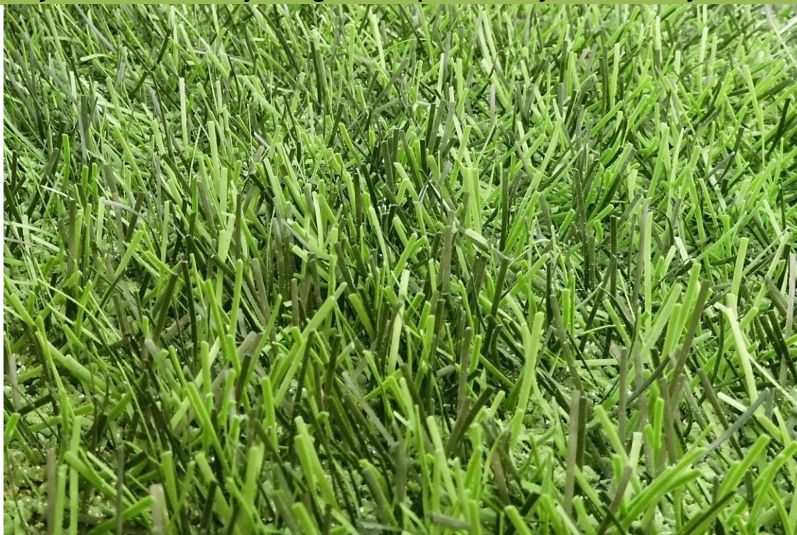
Fig. 10: DOMO Duraforce XSL po 80.000 cyklach na testerze zużycia Lisport
