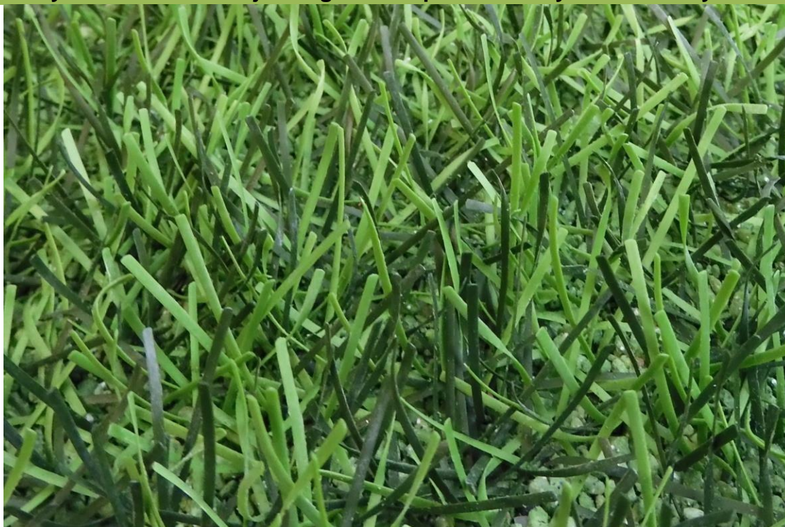
Fig. 24: DOMO Duraforce XSL po 220.000 cyklach na testerze zużycia Lisport
