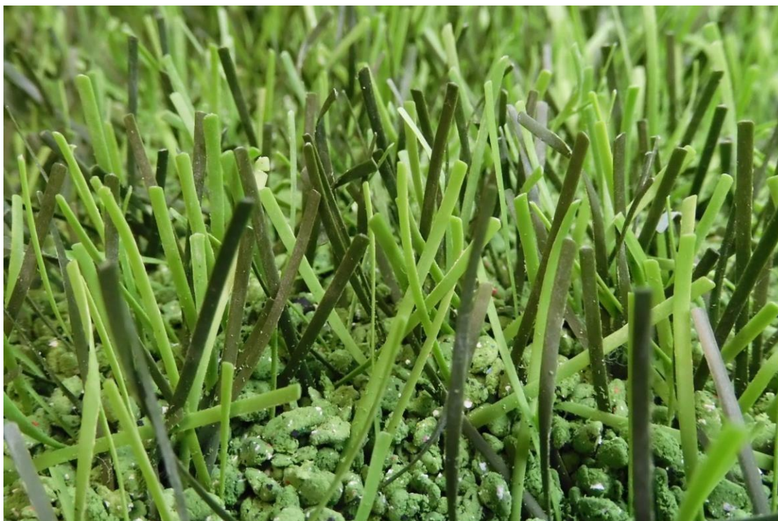
Fig. 19: DOMO Duraforce XSL po 160.000 cyklach na testerze zużycia Lisport
