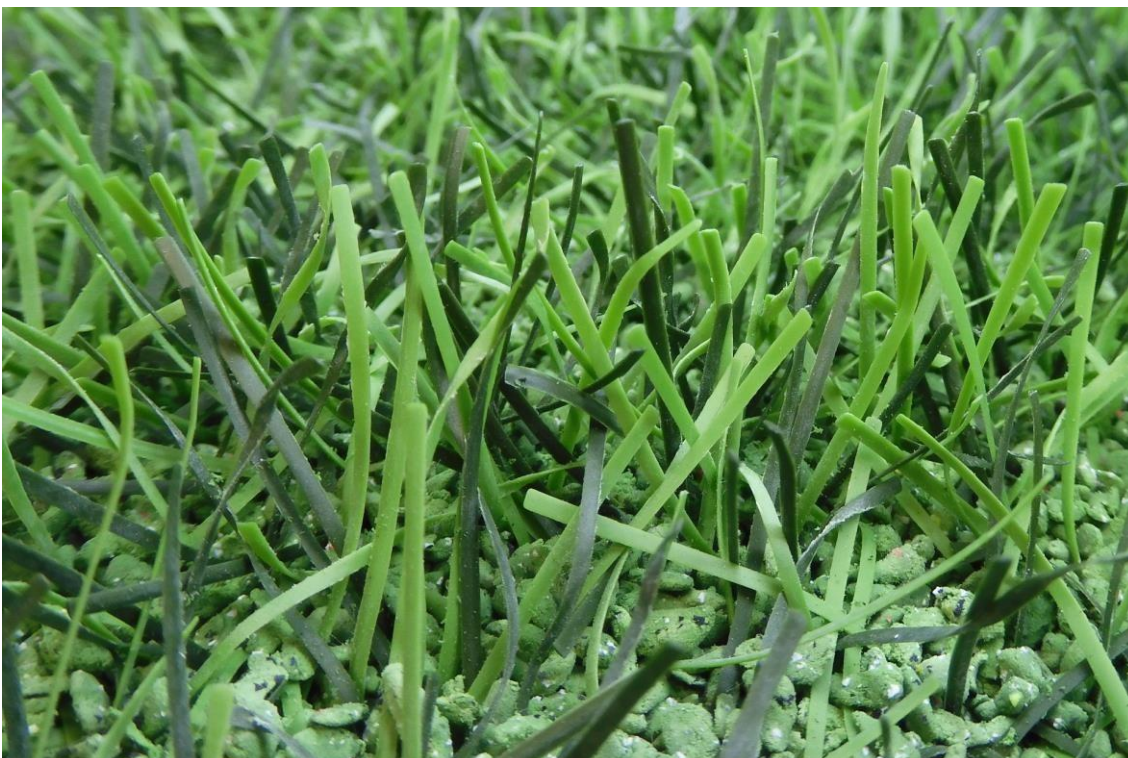
Fig. 23: DOMO Duraforce XSL po 200.000 cyklach na testerze zużycia Lisport
