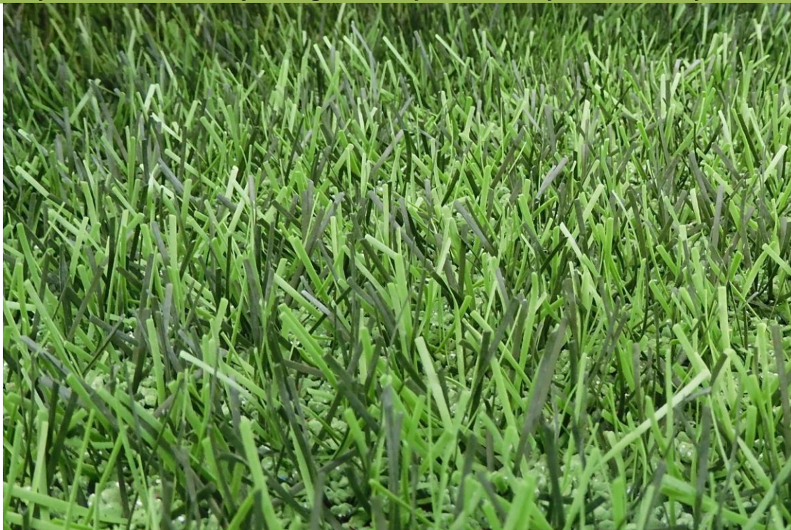
Fig. 12: DOMO Duraforce XSL po 100.000 cyklach na testerze zużycia Lisport
