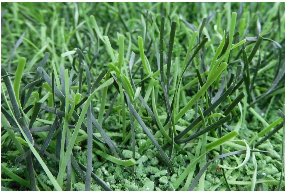
Fig. 33: DOMO Duraforce XSL po 300.000 cyklach na testerze zużycia Lisport
