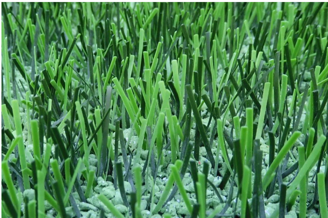
Fig. 9: DOMO Duraforce XSL po 60.000 cyklach testowych
