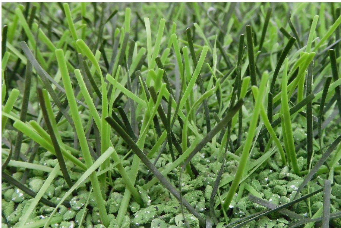
Fig. 27: DOMO Duraforce XSL po 240.000 cyklach na testerze zużycia Lisport
