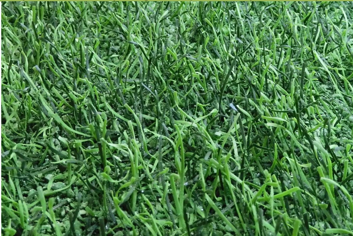
Fig. 32: DOMO Duraforce XSL po 300.000 cyklach na testerze zużycia Lisport
