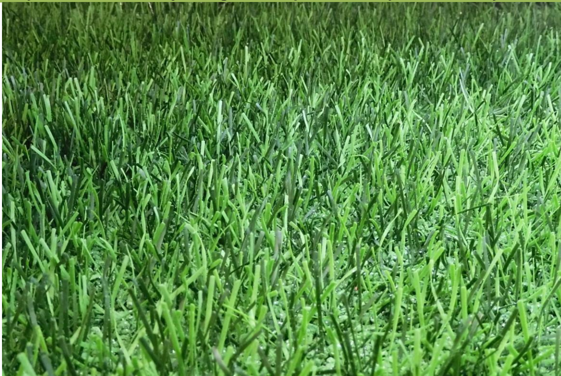
Fig. 16: DOMO Duraforce XSL po 140.000 cyklach na testerze zużycia Lisport
