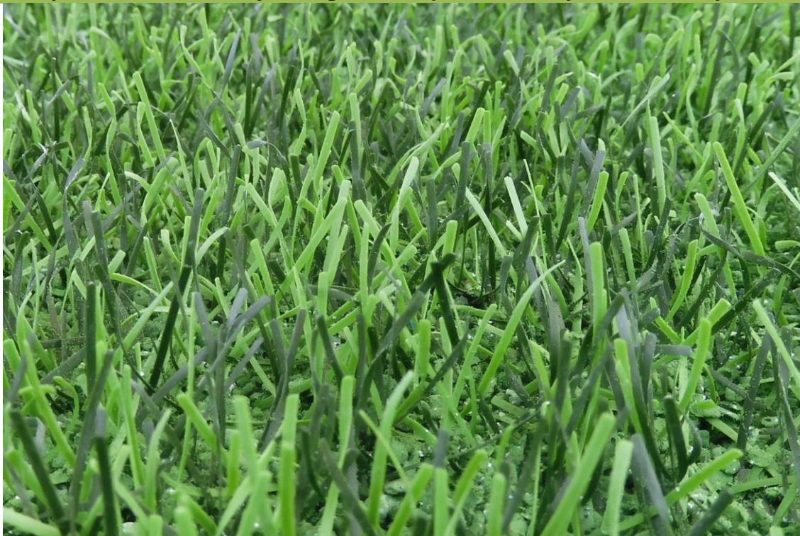
Fig. 26: DOMO Duraforce XSL po 240.000 cyklach na testerze zużycia Lisport
