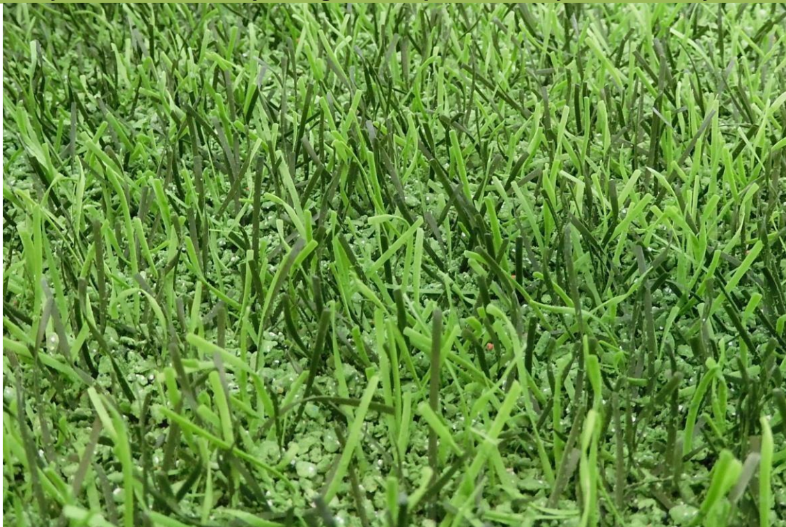
Fig. 22: DOMO Duraforce XSL po 200.000 cyklach na testerze zużycia Lisport
