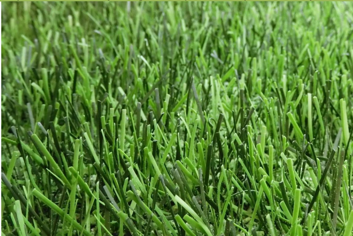
Fig. 14: DOMO Duraforce XSL po 120.000 cyklach na testerze zużycia Lisport
