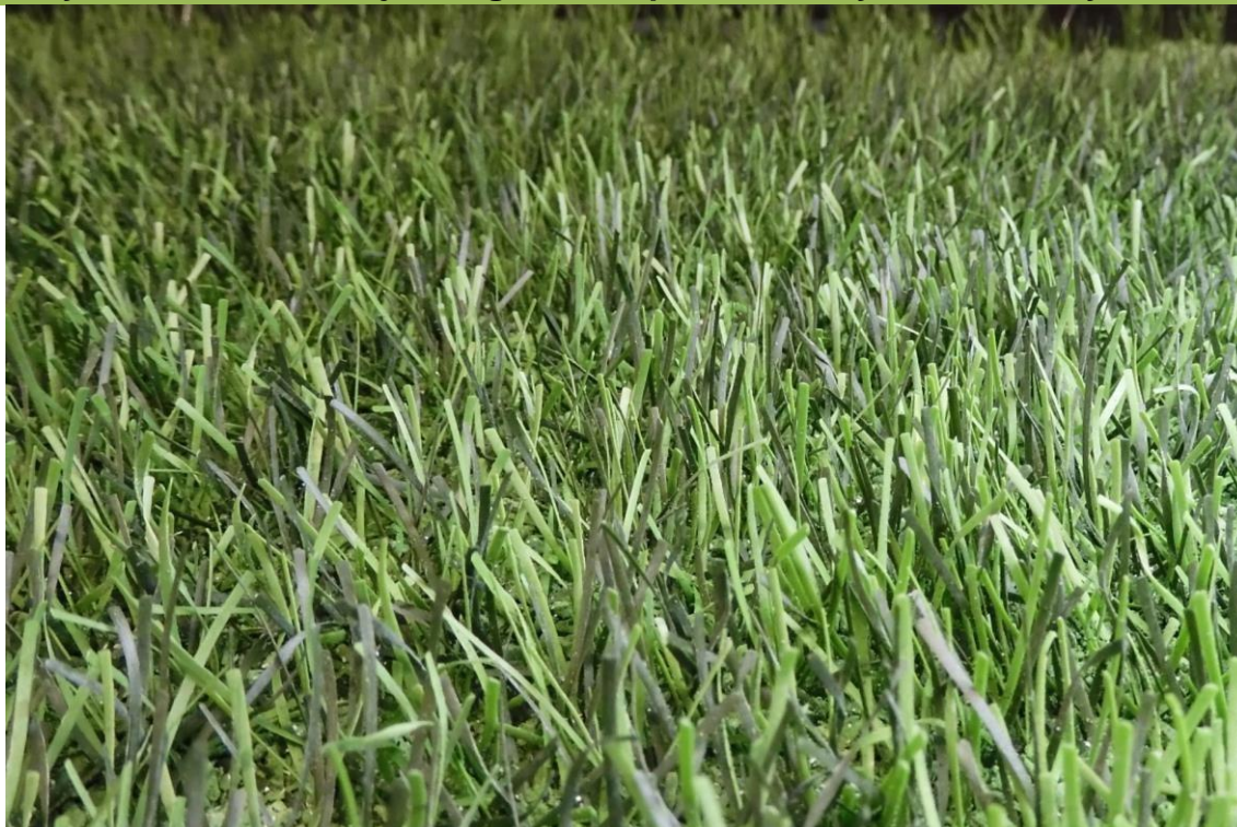
Fig. 18: DOMO Duraforce XSL po 160.000 cyklach na testerze zużycia Lisport
