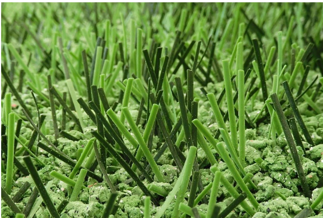
Fig. 7: DOMO Duraforce XSL po 40.000 cyklach w testerze zużycia Lisport
