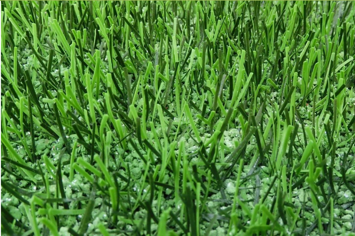
Fig. 8: DOMO Duraforce XSL po 60.000 cyklach testowych
