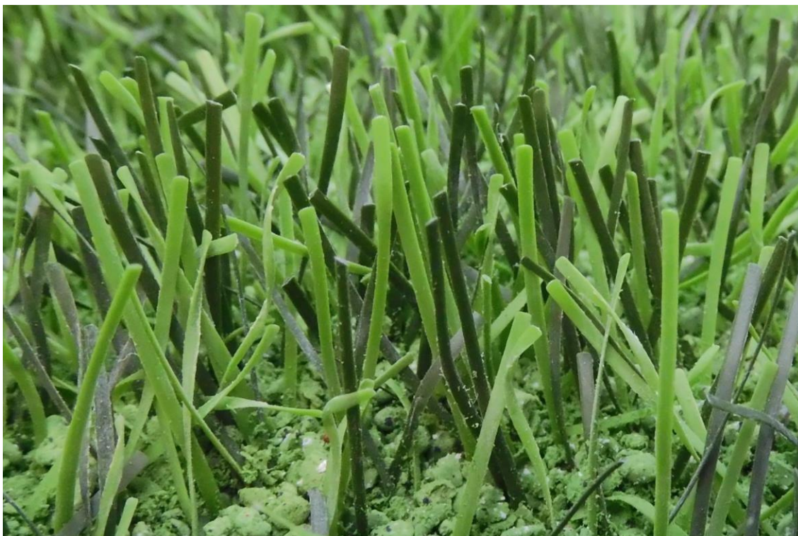
Fig. 21: DOMO Duraforce XSL po 180.000 cyklach na testerze zużycia Lisport
