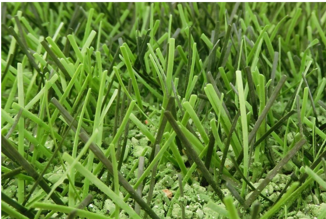
Fig. 15: DOMO Duraforce XSL po 120.000 cyklach na testerze zużycia Lisport
