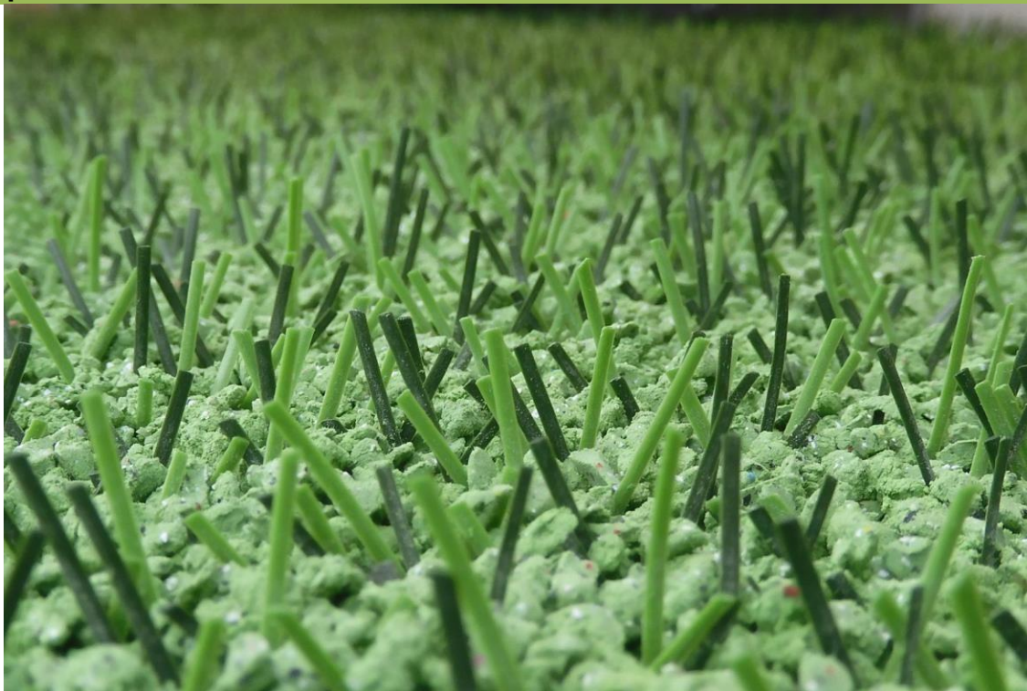
Fig. 4: DOMO Duraforce XSL po 20.000 cyklach na testerze zużycia Lisport
