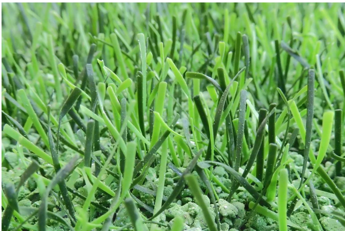
Fig. 29: DOMO Duraforce XSL po 260.000 cyklach na testerze zużycia Lisport
