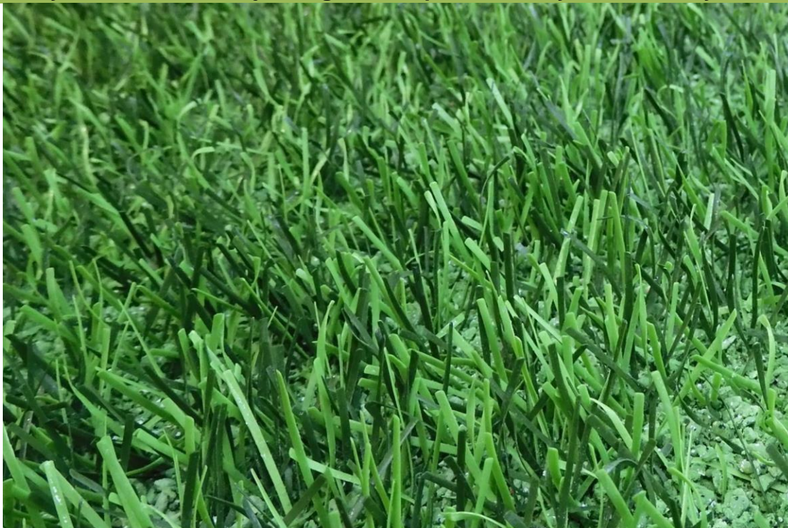
Fig. 20: DOMO Duraforce XSL po 180.000 cyklach na testerze zużycia Lisport
