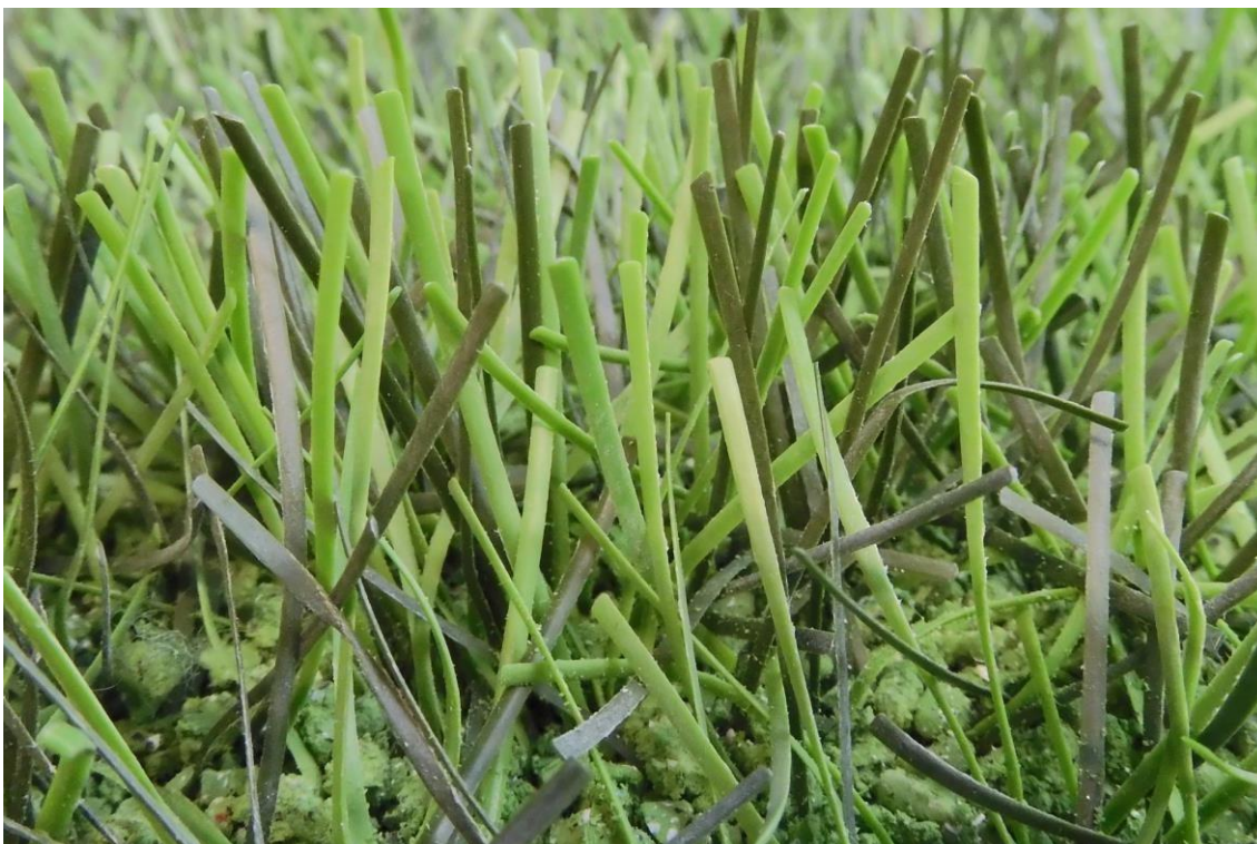
Fig. 11: DOMO Duraforce XSL po 80.000 cyklach na testerze zużycia Lisport
