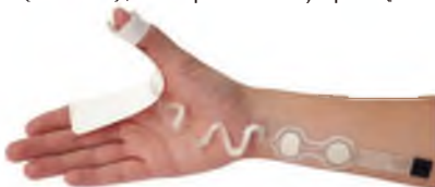
Umieszczenie jednorazowego czujnika ręki i jego elektrod
