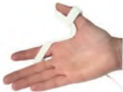
Zamocowanie czujnika na kciuku za pomocą uchwytu
