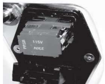
Ryc. 19 – Orientacja wymiany bezpiecznika: pokazana orientacja dla 115 V
