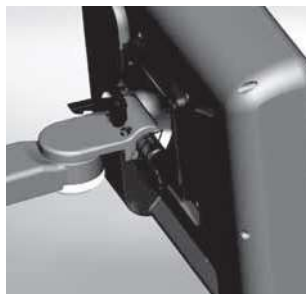
Ryc. 10 – Regulowanie pochYLENIA ekranu dotykowego
