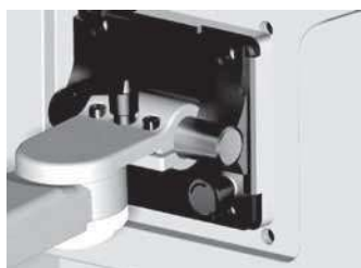
Ryc. 5 – Pokrętko zwalniające na ekranie dotykowym
