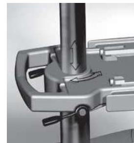
Ryc. 11 – Regulowanie położenia tacy
