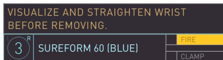
Rysunek 2.15 Wyprostować przegub przed usunięciem staplera
