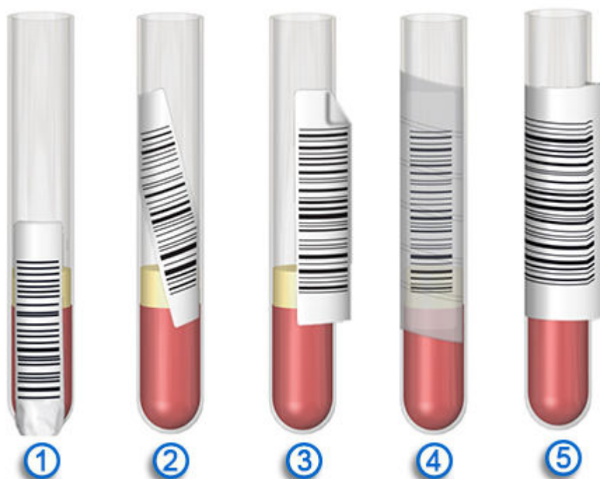
Ilustracja 128: Nieprawidłowe umieszczenie nalepki z kodem paskowym próbki
