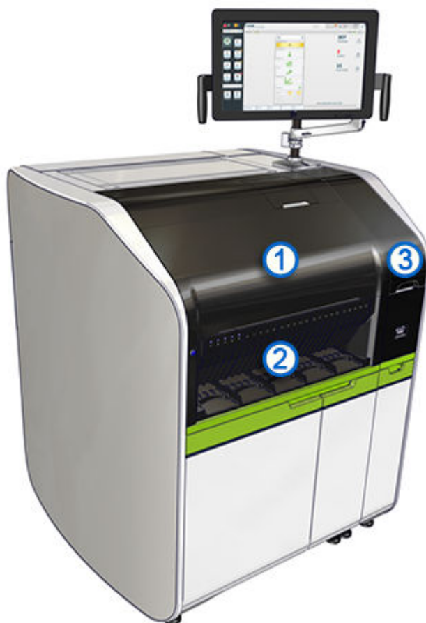
Ilustracja 12: Podstawowe podzespoły analizatora Alinity ci-series
