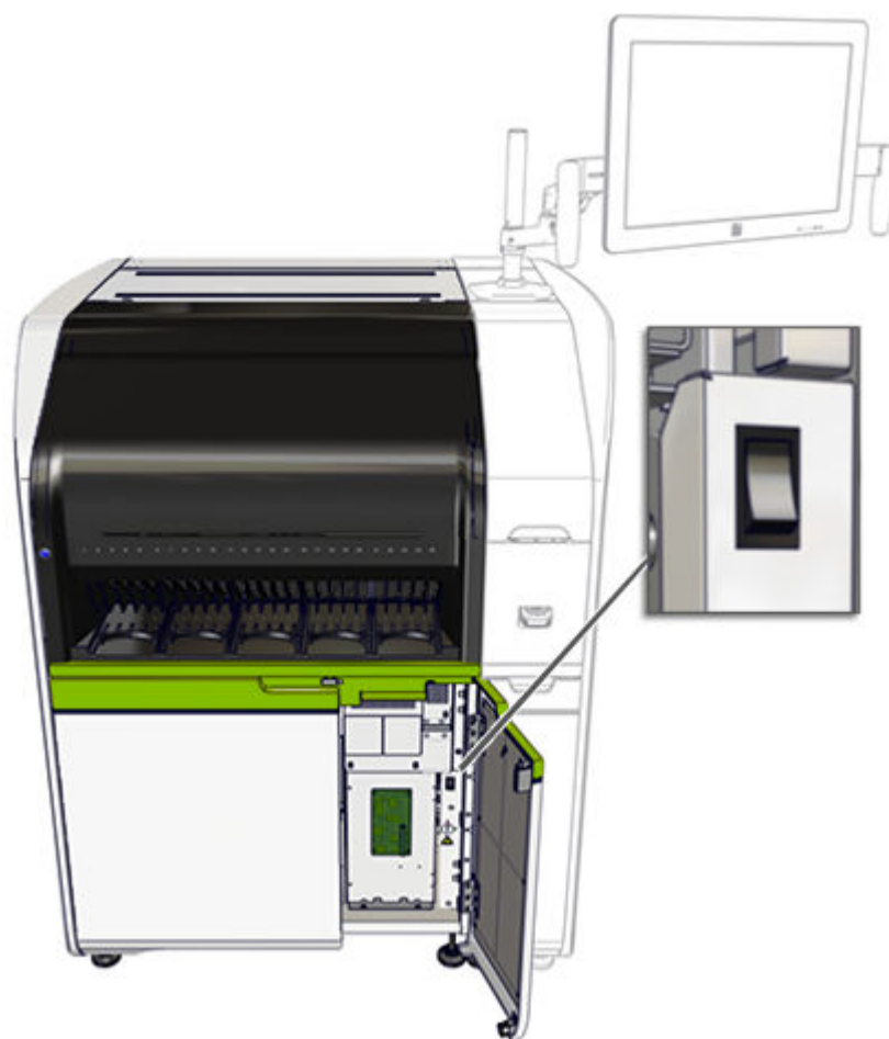
Ilustracja 138: Wyłącznik zasilania modułu roboczego Alinity c
