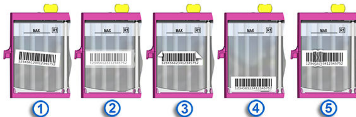
Ilustracja 126: Nieprawidłowe umiejscowienie etykiety z jednowymiarowym kodem paskowym odczytnika (c-series)
