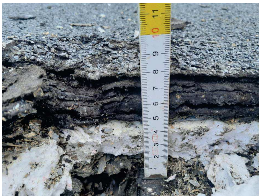
Fot. 4.34 Pomiar warstw pokrycia w lokalizacji nr 3
