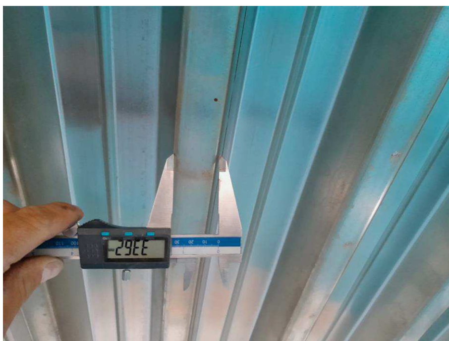
Fot. 4.38 Pomiar szerokości fałdy wypukłej – 33mm
