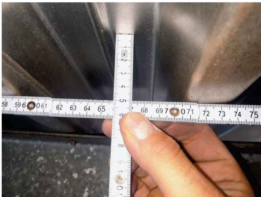
Fot. 4.36 Pomiar wysokości fałdy blachy – 5cm
