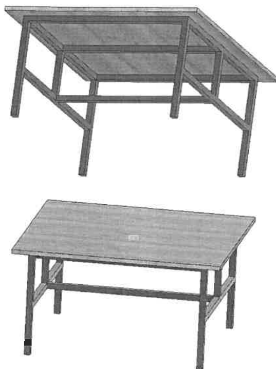
Rys. 10. Stół laboratoryjny 140x150 cm. Widoki przedstawiające ramę nośną, oraz widok z góry na złożony stół.
