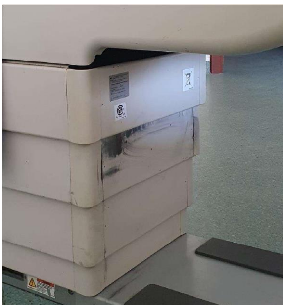
Zidentyfikowane uszkodzenia obudowy gantry i stołu pacjenta TK oraz osłony stołu pacjenta
