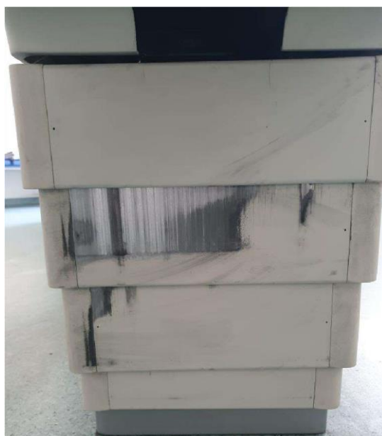
Zidentyfikowane uszkodzenia obudowy gantry i stołu pacjenta TK oraz osłony stołu pacjenta
