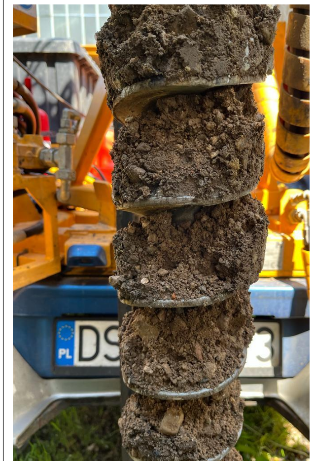
Przykład próby gruntu OW2 głębokość 2,6-3,2 m p.p.t. – żwir piaszczysty
