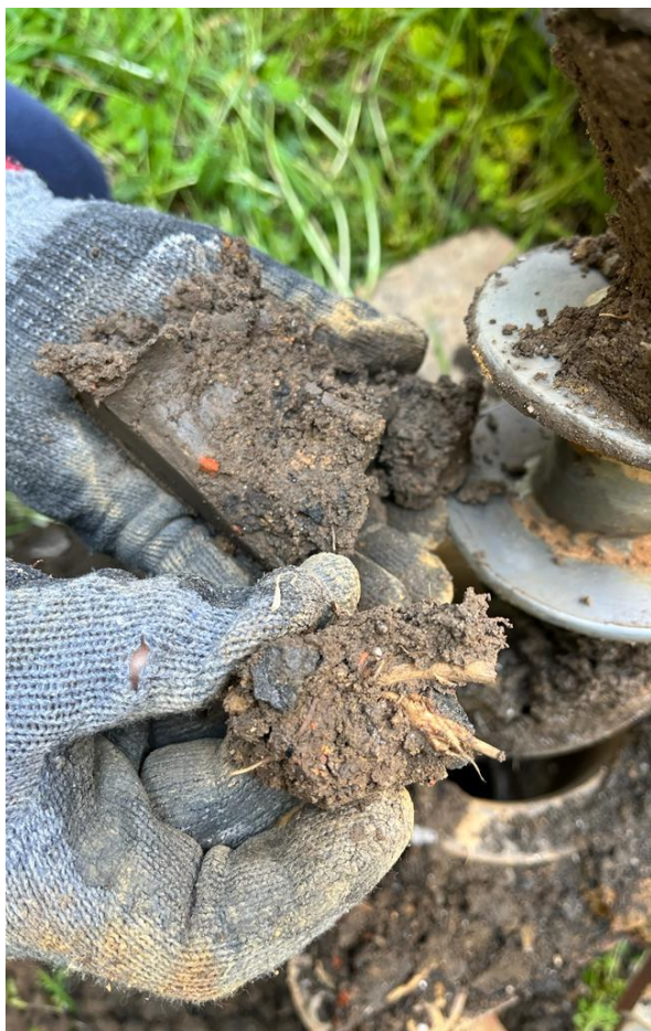
Przykład próby gruntu OW2 głębokość 0,05-1,7 m p.p.t. – szczątki roślin, fragmenty cegieł i szlaki
