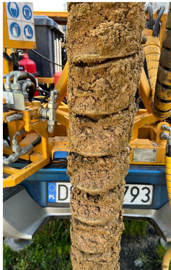
Przykład próby gruntu OW1 głębokość 3,3-5,0 m p.p.t. – pospółka zagliniona przewarstwiona żwirem piaszczystym
