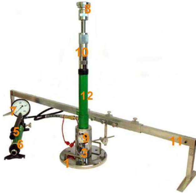
Rys. 1.2 Aparatura VSS z jednopunktowym pomiarem przemieszczenia płyty
