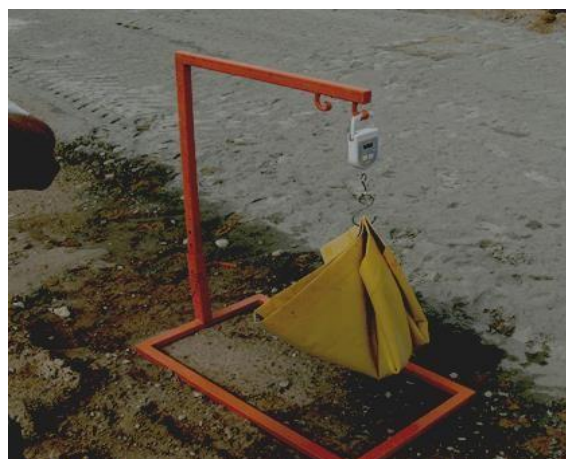
Ważenie tacki pomiarowej ze spoiwem
