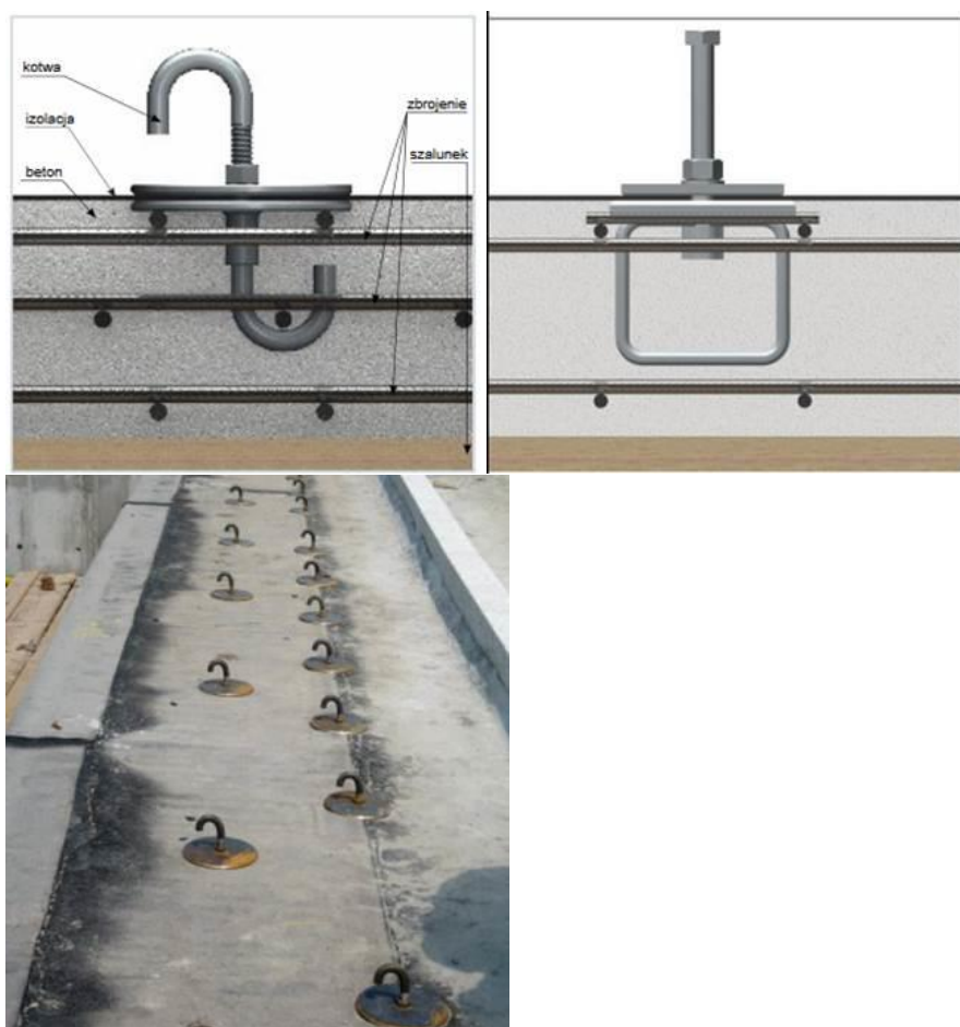
Rys. 9. Dolna część kotwy zabetonowana w ustroju, z dokręconą górną częścią.
