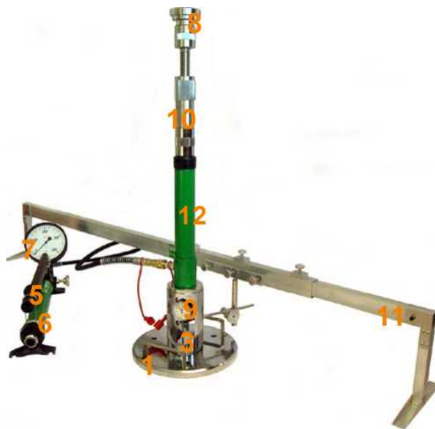
Rys. 1.2 Aparatura VSS z jednopunktowym pomiarem przemieszczenia płyty
