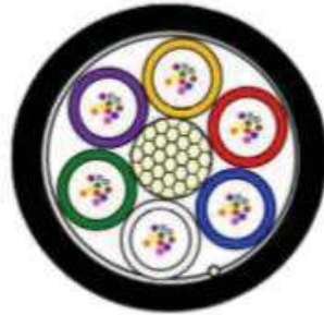
Mikrokabel światłowodowy o konstrukcji 6-tubowej
