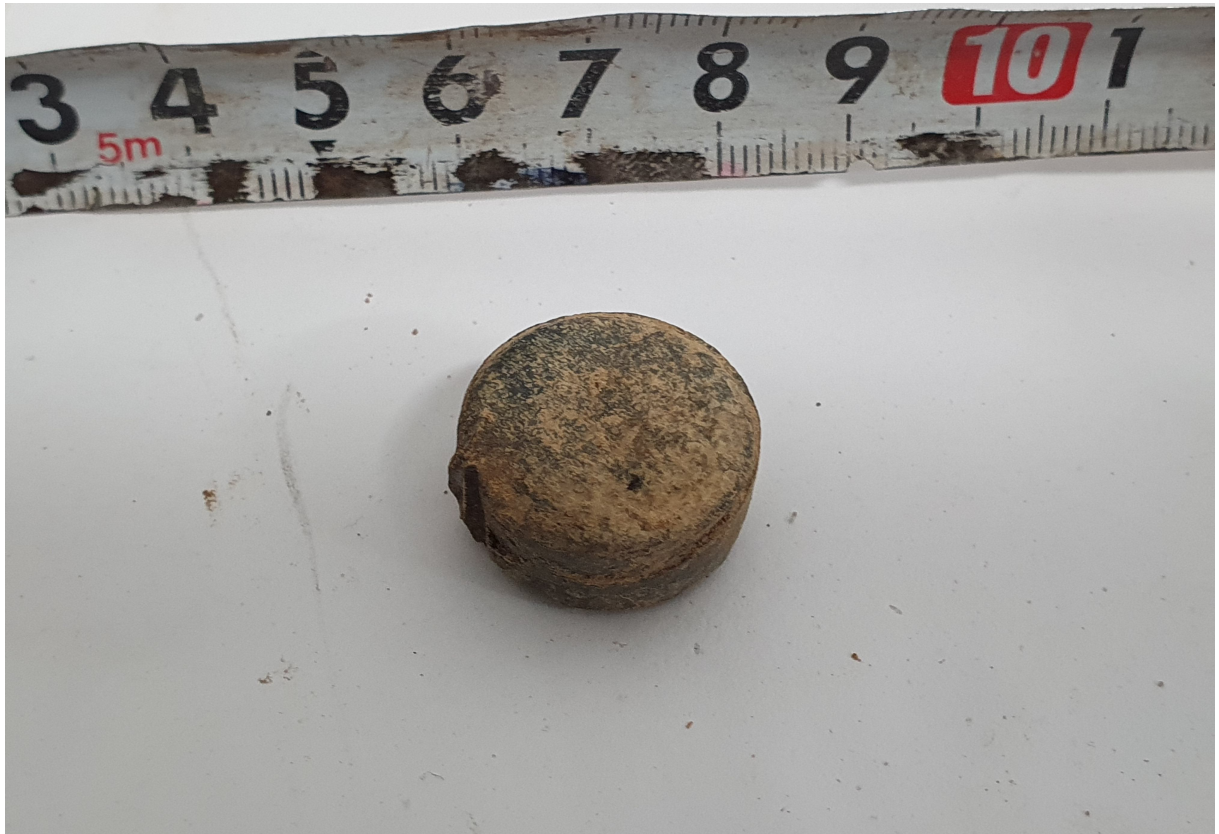
Fotografia numer 7. Wykuty element metalowy z wierzchniej warstwy barytobetonu
