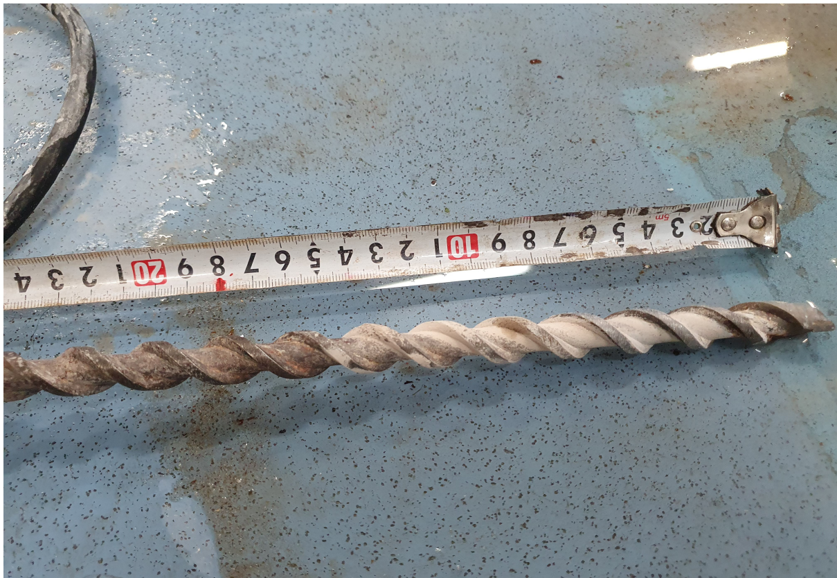
Fotografia numer 5. Głębokość około 10cm na jaka przewiercony chudy beton
