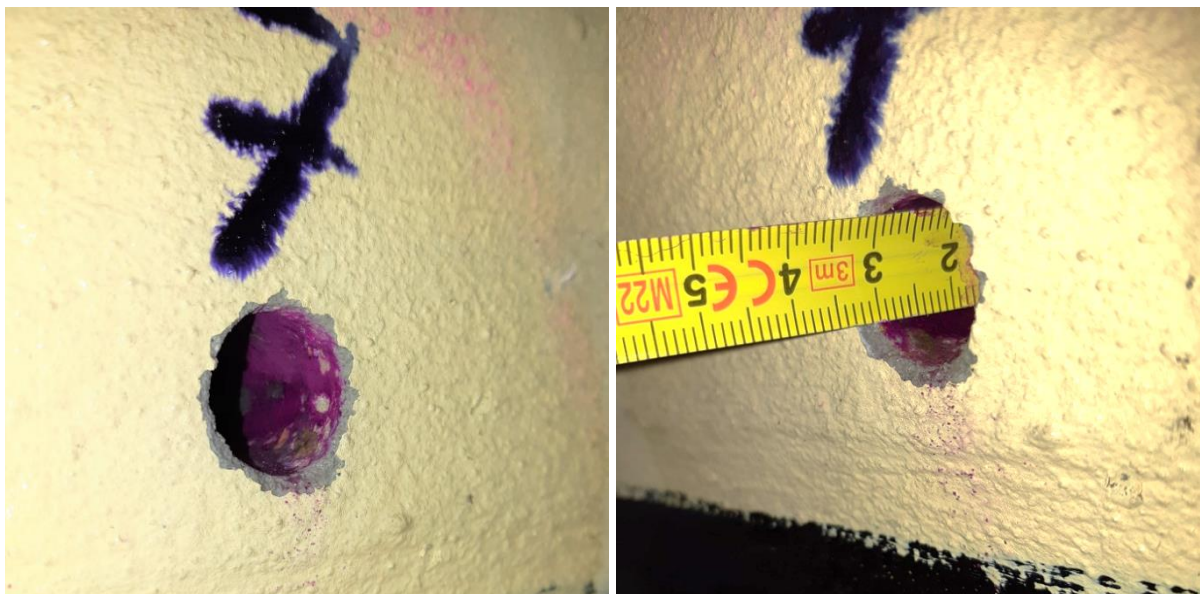
Fot. 3.7 Pomiar zasięgu karbonatyzacji betonu w punkcie nr 7 – maksymalny odczyt zasięgu karbonatyzacji – 3 mm
