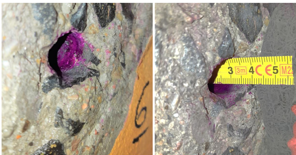
Fot. 3.6 Pomiar zasięgu karbonatyzacji betonu w punkcie nr 6 – maksymalny odczyt zasięgu karbonatyzacji – 28 mm
