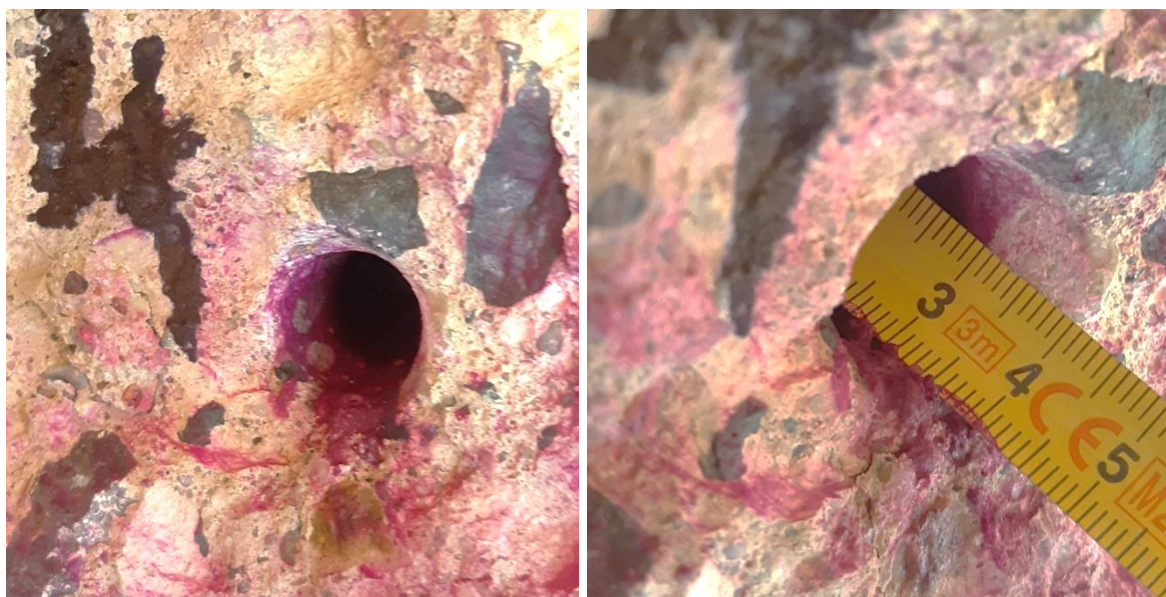
Fot. 3.4 Pomiar zasięgu karbonatyzacji betonu w punkcie nr 4 – maksymalny odczyt zasięgu karbonatyzacji – 30 mm
