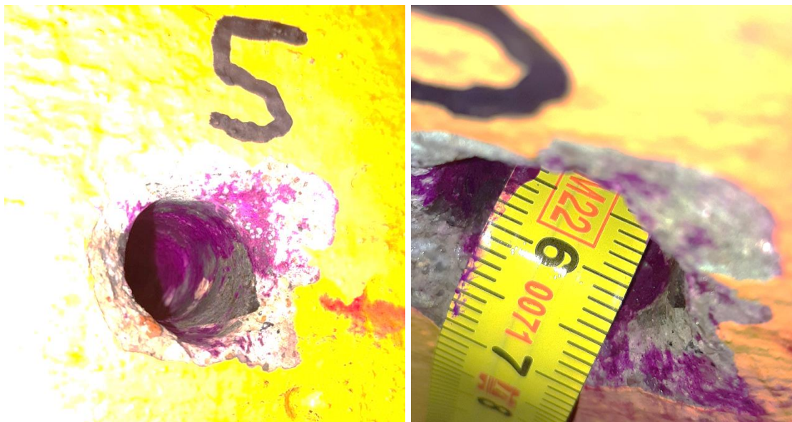
Fot. 3.5 Pomiar zasięgu karbonatyzacji betonu w punkcie nr 5 – maksymalny odczyt zasięgu karbonatyzacji – 15 mm
