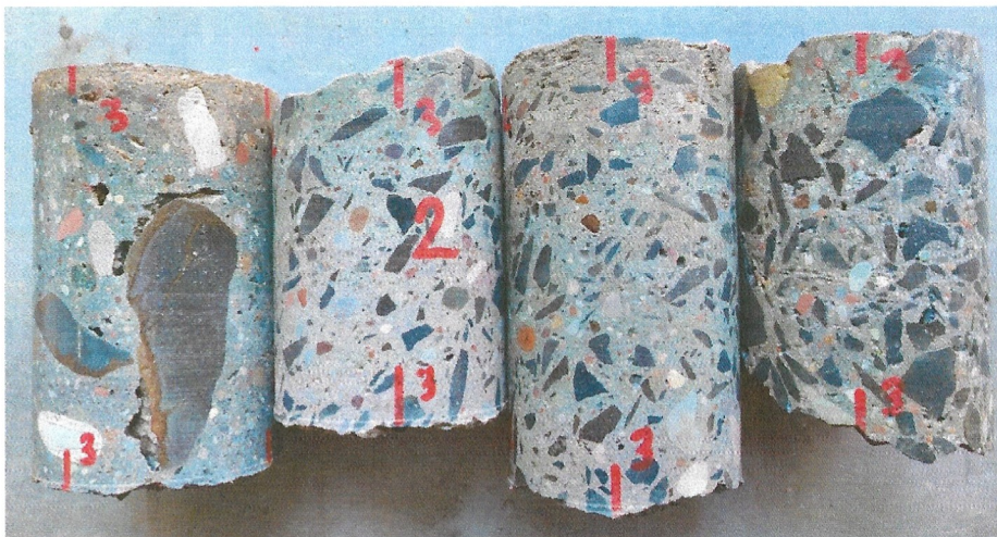
Rys. 6. Odwierty pobrane do badań, od lewej Nr 1, Nr 2, Nr 3 i Nr 4. Strona 3. Pobocznica 180°
