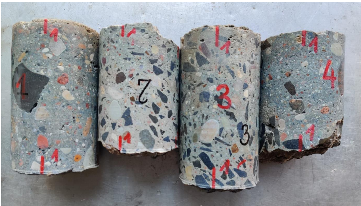
Fot. 28. Betonowe próbki walcowe z odwiertów rdzeniowych
