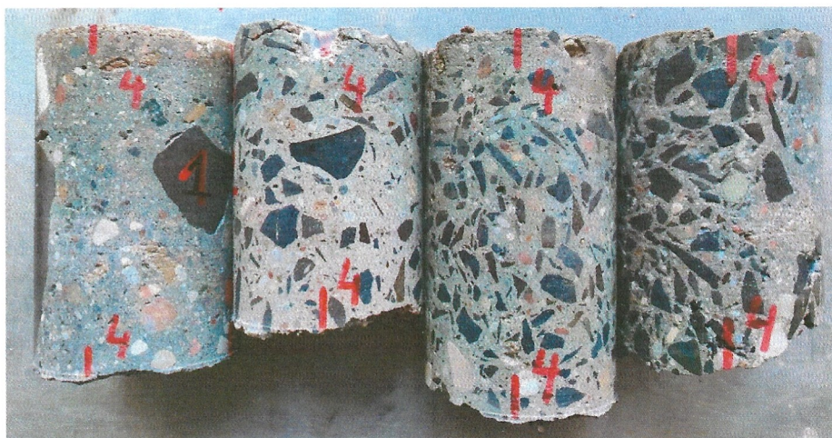
Rys. 7. Odwierty pobrane do badań, od lewej Nr 1, Nr 2, Nr 3 i Nr 4. Strona 4. Pobocznica 270°
