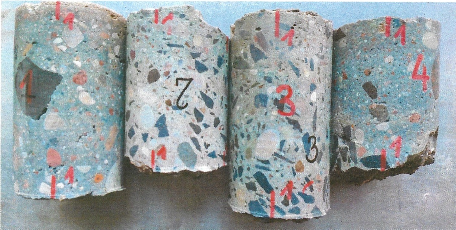
Rys. 4. Odwierty pobrane do badań, od lewej Nr 1, Nr 2, Nr 3 i Nr 4. Strona 1. Pobocznica 0°.
