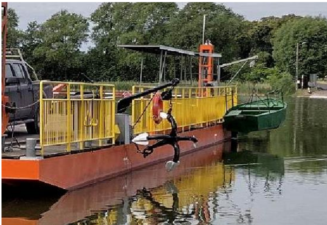
Fotografia 7. Wyposażenie promu – kotwica, koło ratunkowe i łódź towarzysząco-ratownicza (fot. z dnia 7 czerwca 2023).
