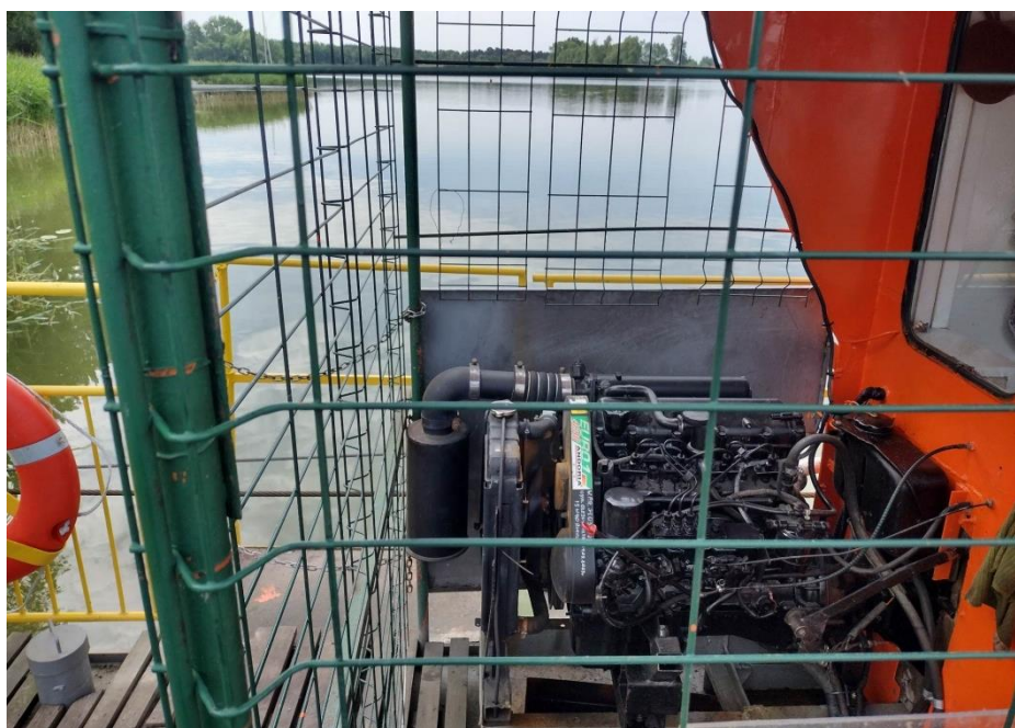
Fotografia 8. Silnik diesla do napędu liny na pokładzie promu OSTRÓWEK II (fot. z dnia 7 czerwca 2023).
