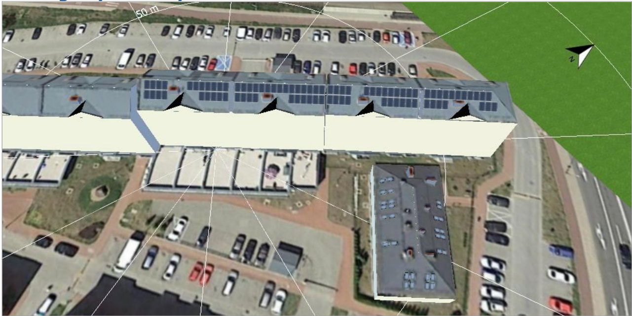
Rysunek 2: Umieszczenie generatora fotowoltaicznego i grupy przetwornic
