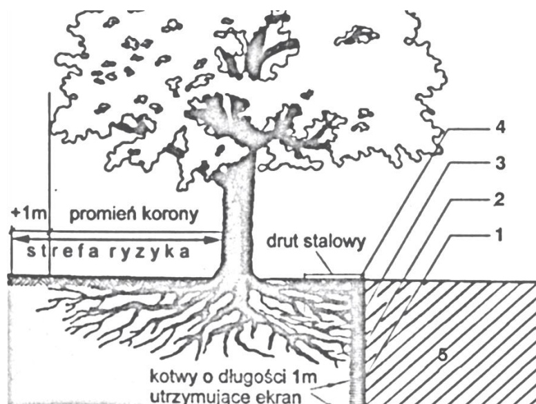
Ryc. 35.: Przykładowy sposób prawidłowego wykonania ekranu korzeniowego: 1– szalunek z desek, 2 – folia, 3 – ziemia urodzajna, 4 – bryła korzeniowa drzewa z przyciętymi korzeniami, 5 – projektowany wykop (źródło: Poradnik chirurgia i pielęgnacja drzew, Chachulski, 2000)
