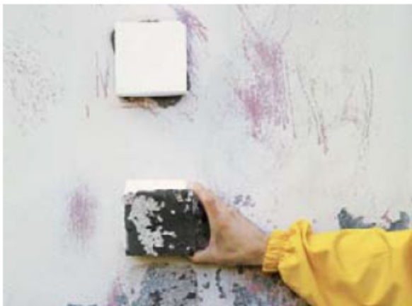
Fot. 1, 2. Badanie przyczepności podłoża.
