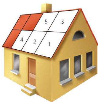
Rys. 3. Ogólny schemat kolejności montażu arkuszy blach na dachu (źródło: instrukcja montażu producenta).
