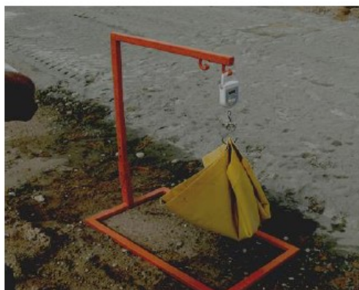
Ważenie tacki pomiarowej ze spoiwem
