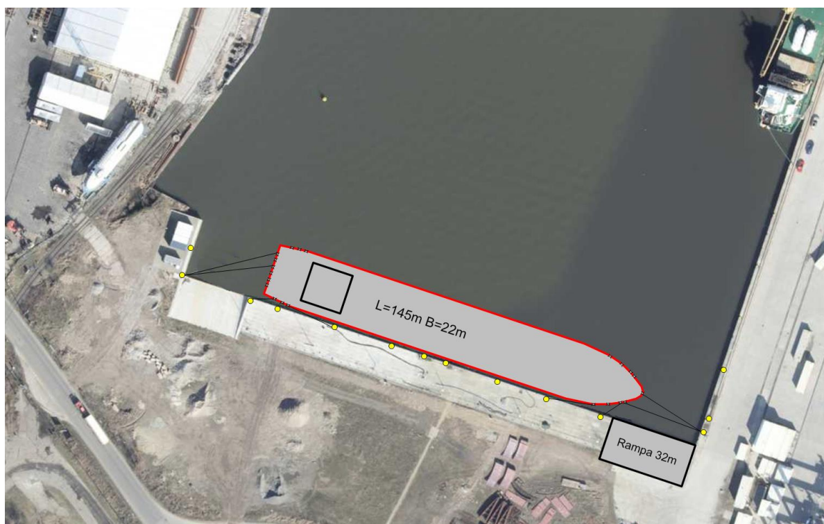
Rys. 2.2. Jednostka maksymalna L=145m zacumowana w sposób 4+4 do nab. Spółdzielczego po modernizacji.
