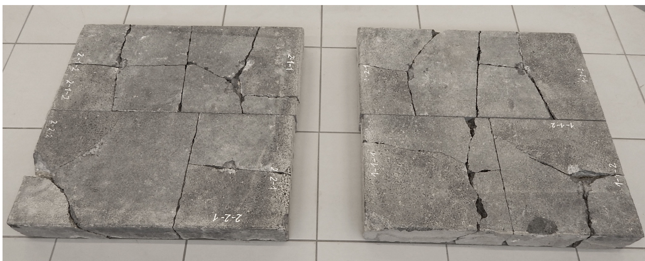
Rys. 27. Płyty po badaniach wytrzymałościowych
