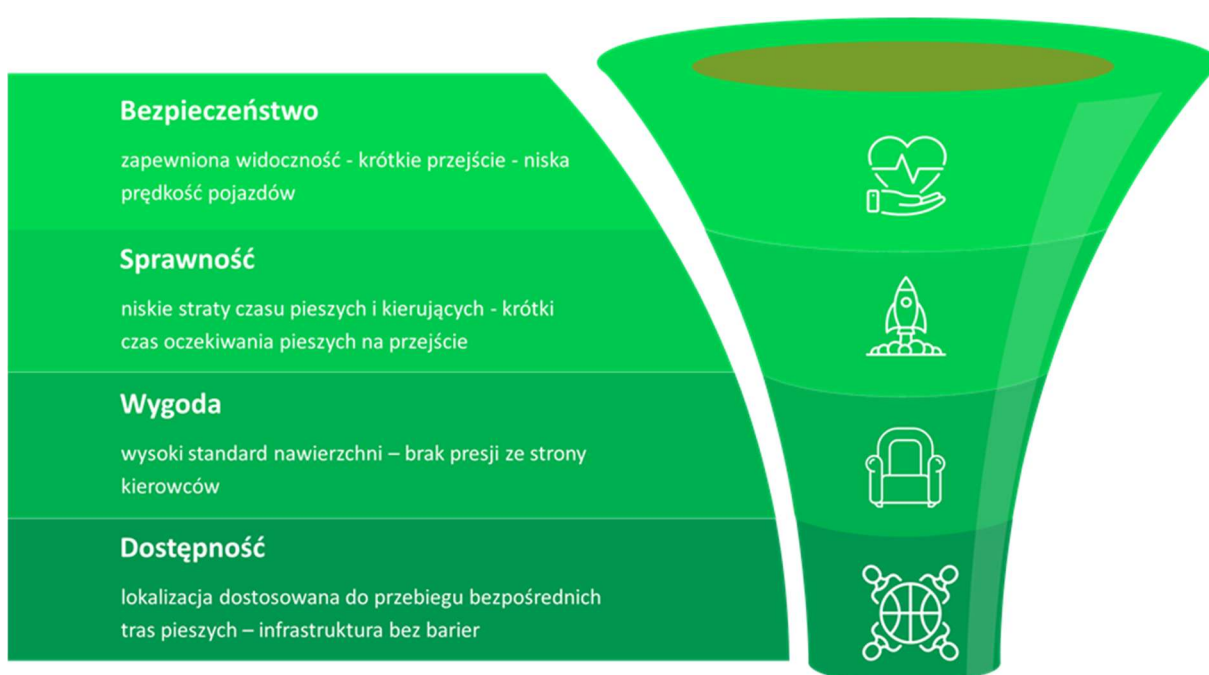
Rys. 8.1. Kryteria projektowania infrastruktury punktowej dla pieszych
