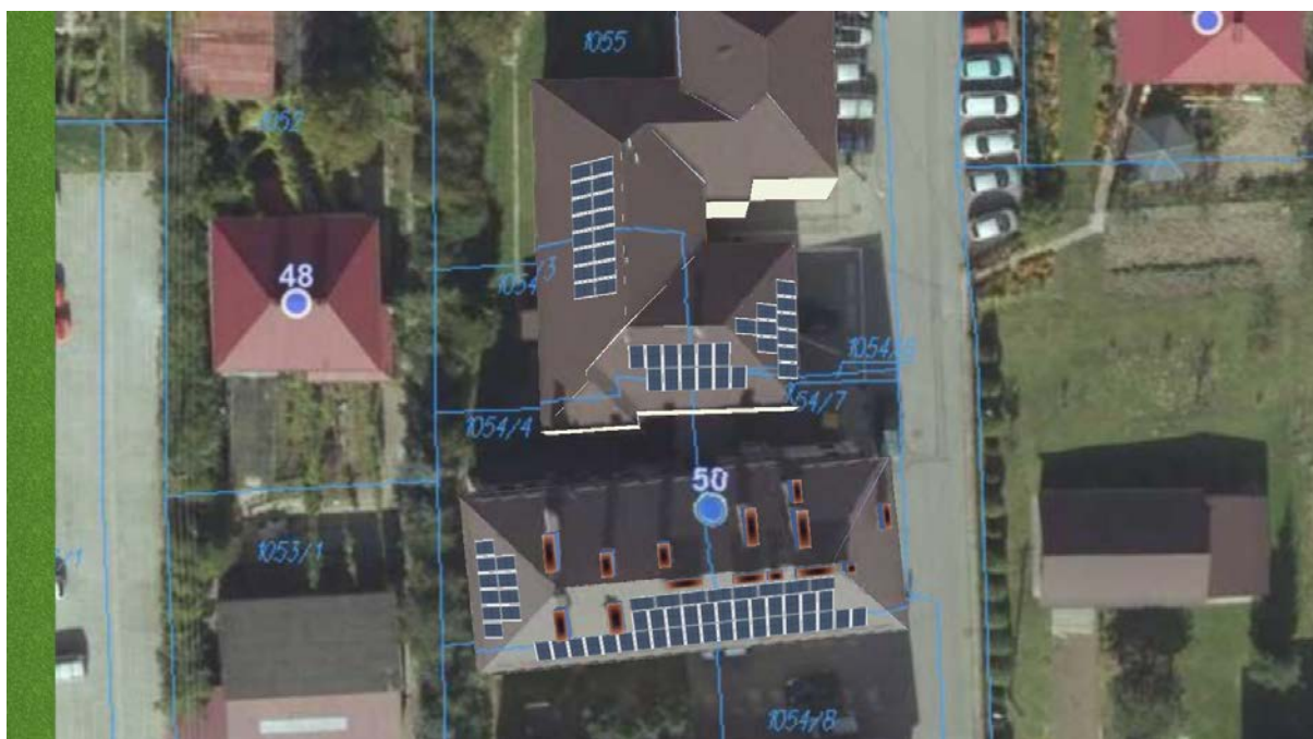
proj. rozmieszczenie modułów PV dla mikroinstalacji nr 1
