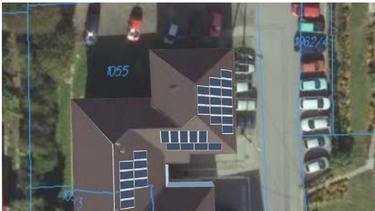
proj. rozmieszczenie modułów PV dla mikroinstalacji nr 2
