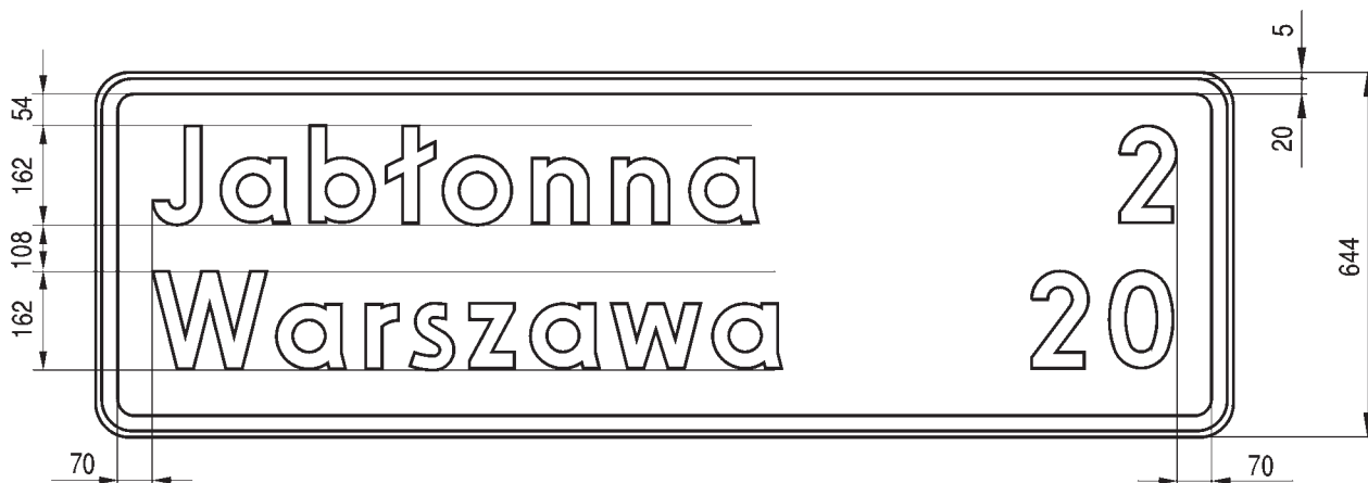
Rys. 9.5.43. Konstrukcja znaku E-13
