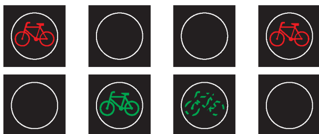
Rys. 4.4.1. Sygnalizator S-6 dla rowerzystów z sekwencją nadawanych sygnałów
