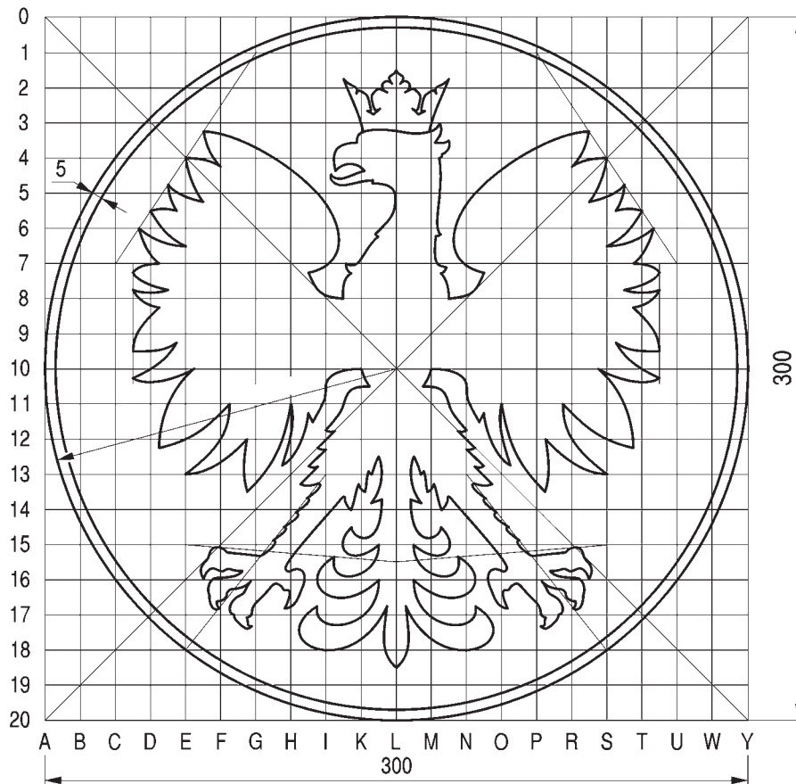
Rys. 9.6.3. Szablon orła do znaków F-1 i F-2
