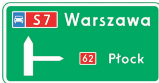
Rys. 6.3.1.7. Tablica E-1 na początku drogi ekspresowej
