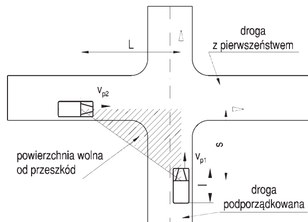
Rys. 3.2.21.2. Widoczność na zatrzymanie się przed skrzyżowaniem
