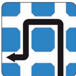
Rys. 7.2.7.2. Znak F-7 wskazujący możliwość skręcania w lewo na następnym skrzyżowaniu
