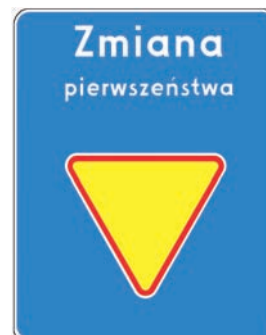
Rys. 5.2.54.2. Znak D-48 wskazujący wlot podporządkowany
