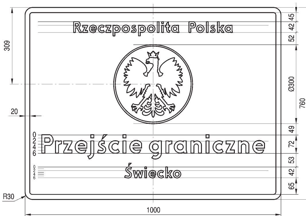
Rys. 9.6.1. Konstrukcja znaku F-1
