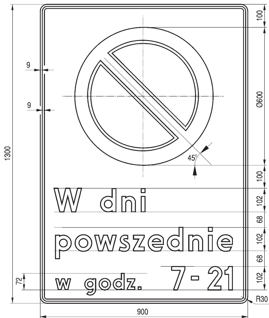
Rys. 9.2.47. Konstrukcja znaku B-39
