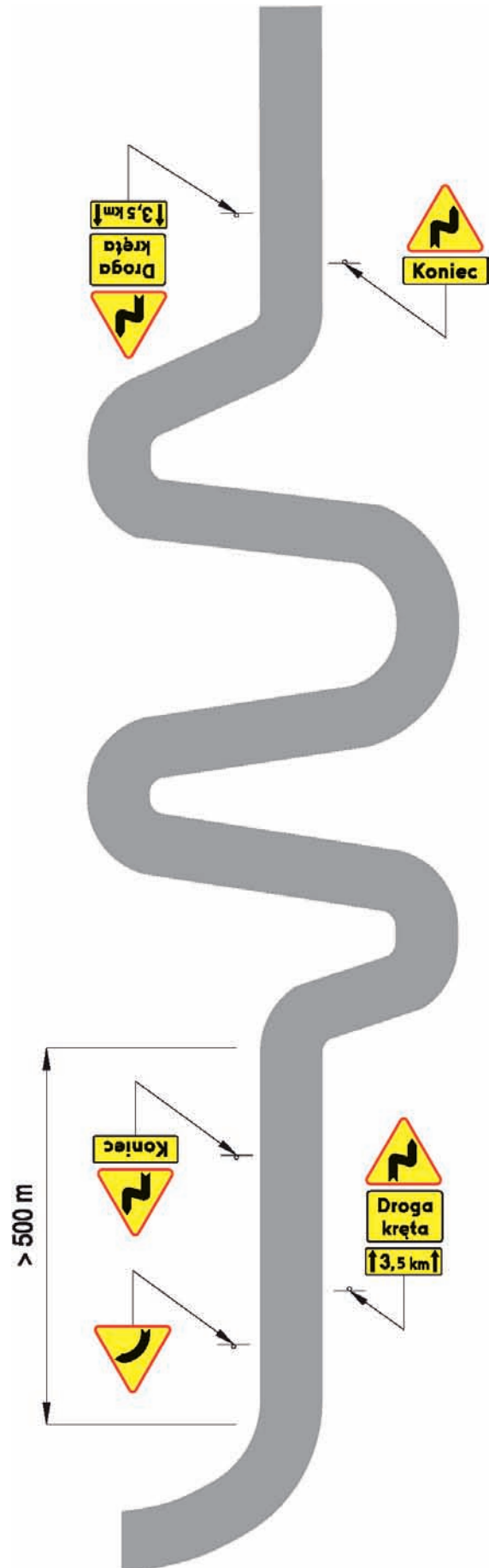
Rys. 2.2.3.4. Oznakowanie drogi z niebezpiecznymi zakrętami
