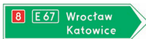
Rys. 6.3.2.10. Drogowskaz E-3 z dwiema nazwami miejscowości kierunkowych
