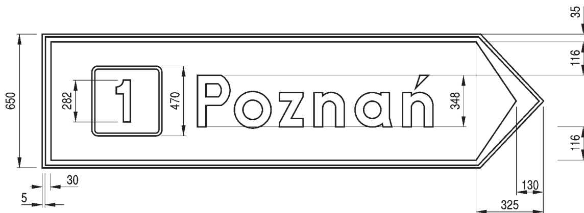
Rys. 9.5.24. Konstrukcja znaku E-3
