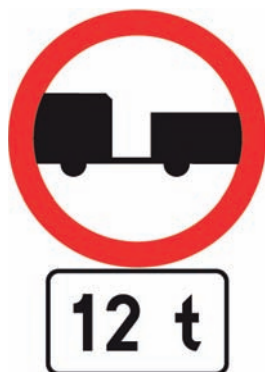
Rys. 3.2.8.3. Znak B-7 z tabliczką podającą masę przyczepy
