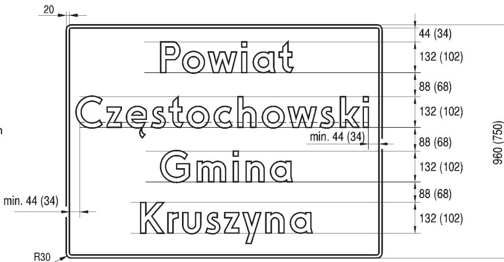
Rys. 9.6.5. Konstrukcja znaku F-3b
