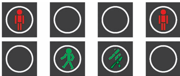
Rys. 4.3.1. Sygnalizator S-5 dla pieszych z sekwencją nadawanych sygnałów
