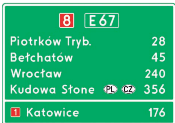
Rys. 6.3.6.2. Tablica E-14 z nazwami dwóch miejscowości kierunkowych
