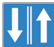
Rys. 7.2.15.2. Znak F-15 dla jezdni dwupasowej dwukierunkowej
