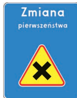
Rys. 5.2.54.1. Znak D-48 wskazujący skrzyżowanie dróg równorzędnych
