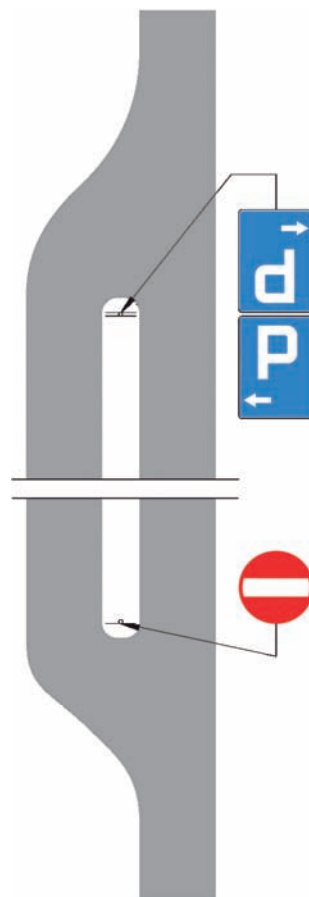
Rys. 3.2.2.5. Zastosowanie znaku B-2 w obiekcie przydrożnym
