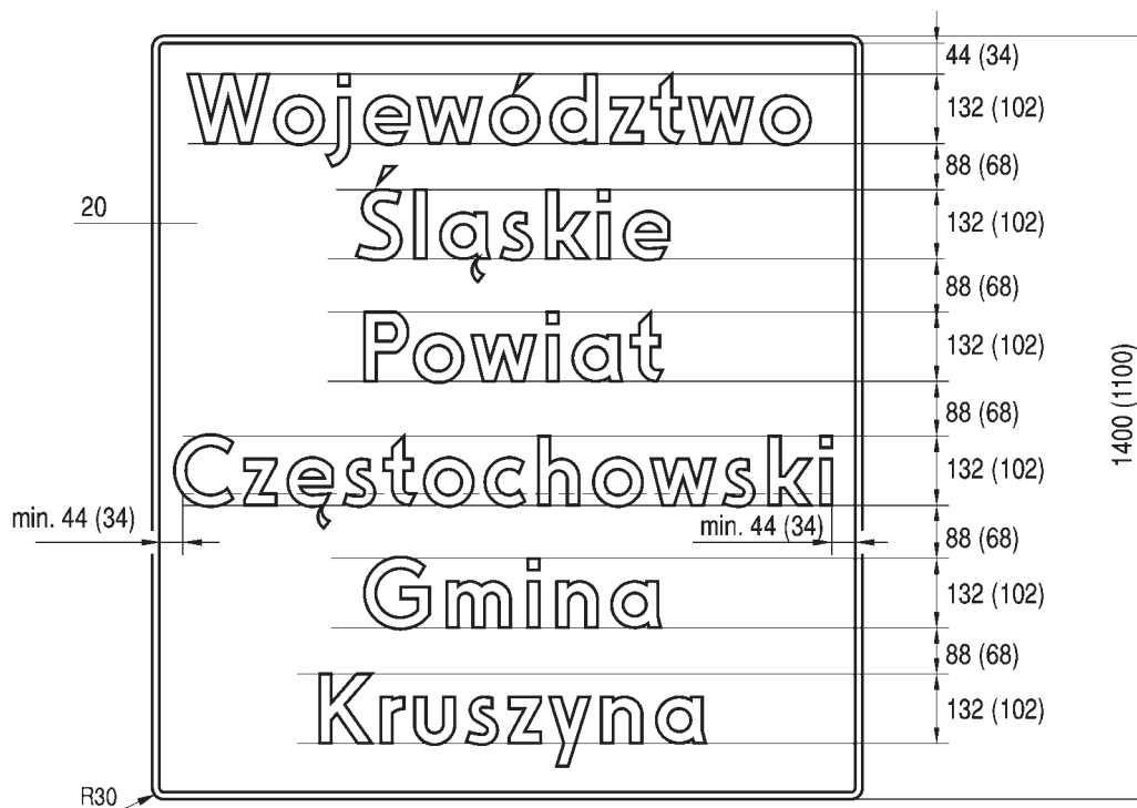
Rys. 9.6.4. Konstrukcja znaku F-3a
