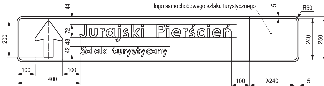
Rys. 9.5.54. Konstrukcja znaku E-22a
