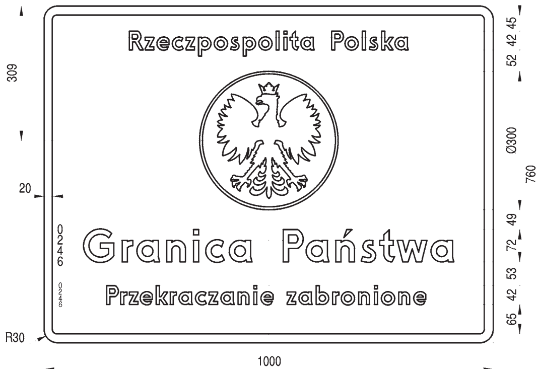
Rys. 9.6.2. Konstrukcja znaku F-2
