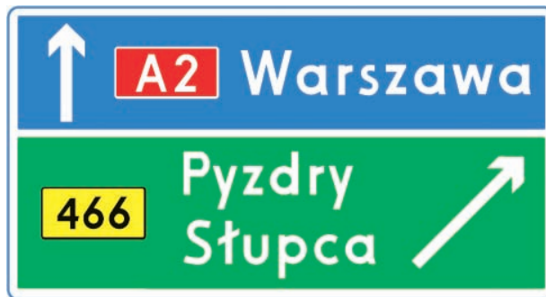
Rys. 6.3.2.5. Drogowskaz E-2c na autostradzie
