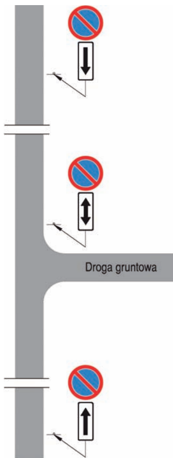
Rys. 3.2.36.6. Zastosowanie tabliczek T-25a, T-25b, T-25c
