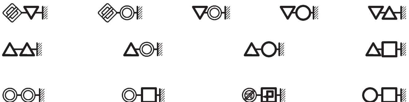
Rys. 1.5.2. Sposoby umieszczania dwóch znaków w układzie poziomym
