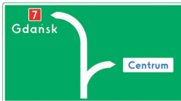
Rys. 6.3.1.6. Tablica E-1 podająca informację lokalną
