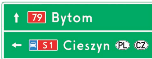
Rys. 6.3.2.4. Drogowskaz E-2a wskazujący dojazd do drogi ekspresowej
