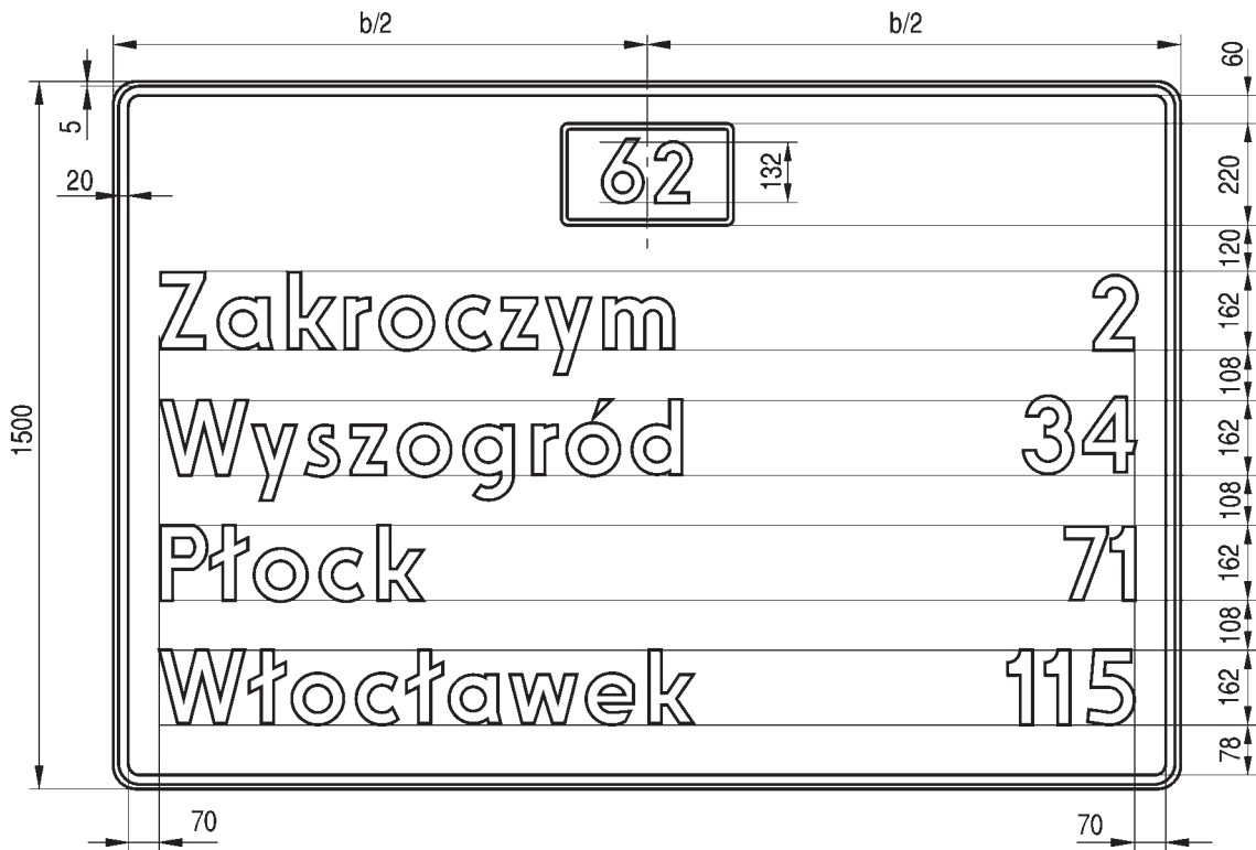
Rys. 9.5.44. Konstrukcja znaku E-14
