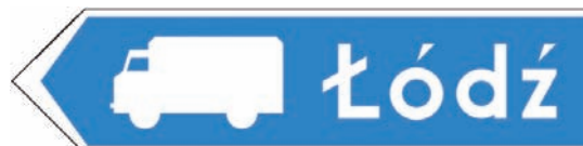
Rys. 7.2.13.2. Znak F-13 wskazujący przejazd tranzytowy do miejscowości
