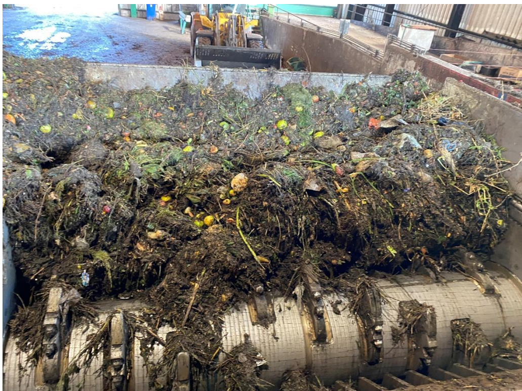
Rys. 1. Odpady biodegradowalne o wysokiej wilgotności i lepkości w komorze rozdrabniacza
