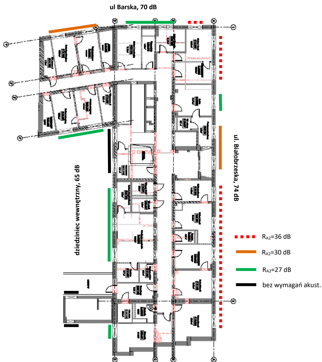
Rys. 2. Izolacyjność akustyczna okien R A2 . Budynek C
