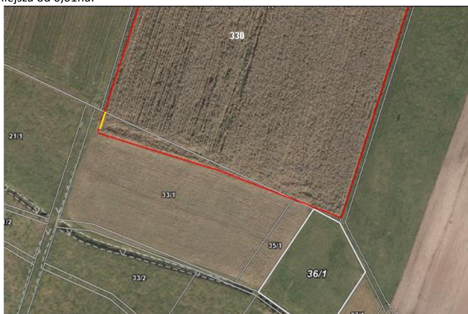
Rys. 46. Odchyłka wektora pomiaru działki rolnej A i granic odniesienia działki referencyjnej 330 jest większa od maksymalnej odchyłki dopuszczalnej dla danej techniki pomiaru, ale powierzchnia obszaru wychodzącego poza wartość dopuszczalnej odchyłki jest mniejsza od 0,01ha
