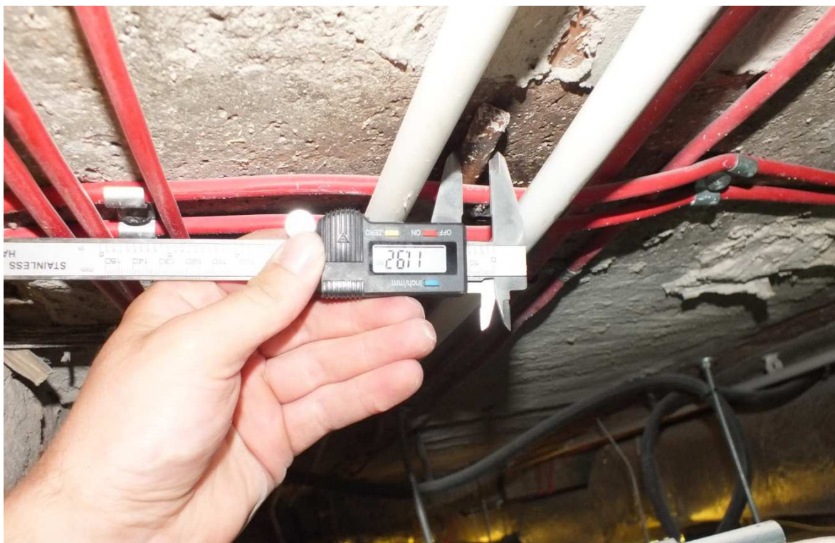
Fot. Z.2.1 Bezpośredni pomiar zbrojenia przęsłowego stropu nad VI piętrem (zbrojenie stropu wielkopłytkowego na bazie stropu Akerman)
