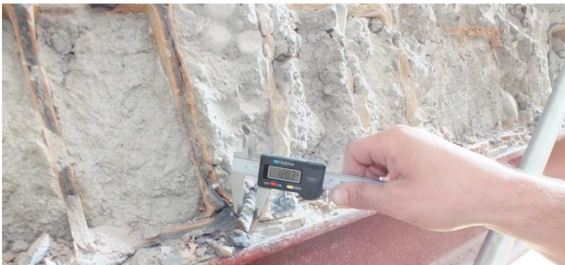
Fot. Z.2.7 Bezpośredni pomiar zbrojenia stropu w obrębie klatki schodowej cz.3
