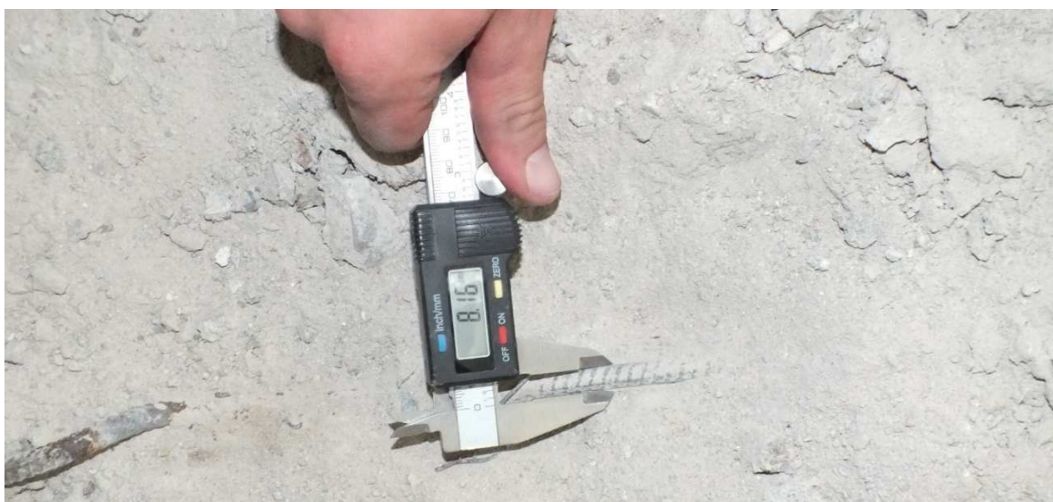
Fot. 5.3.4 Pomiar rzeczywisty zbrojenia podporowego stropu wykonany podczas oględzin
