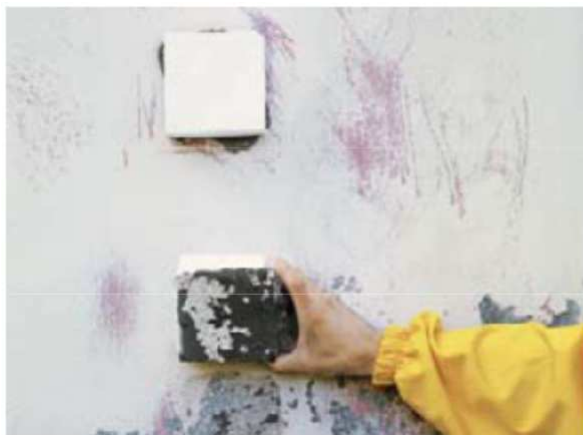
Fot. 1, 2. Badanie przyczepności podłoża.
