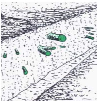
Rys. 3. Postępowanie z korzeniami uszkodzonymi w wykopach. Przycięcie korzeni i zabezpieczenie środkiem do pielęgnowania ran. (rys. pochodzi z European Treeworker, wyd. European Arbicultural Council).
