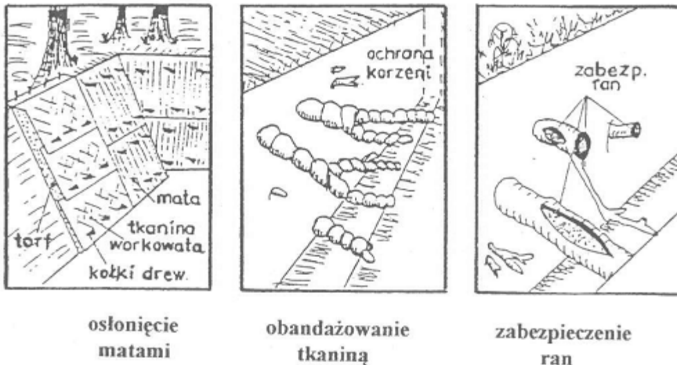
Rys. 5. Zabezpieczenie korzeni (rys. pochodzi z "Chirurgia drzew" Z. Chachulski).
