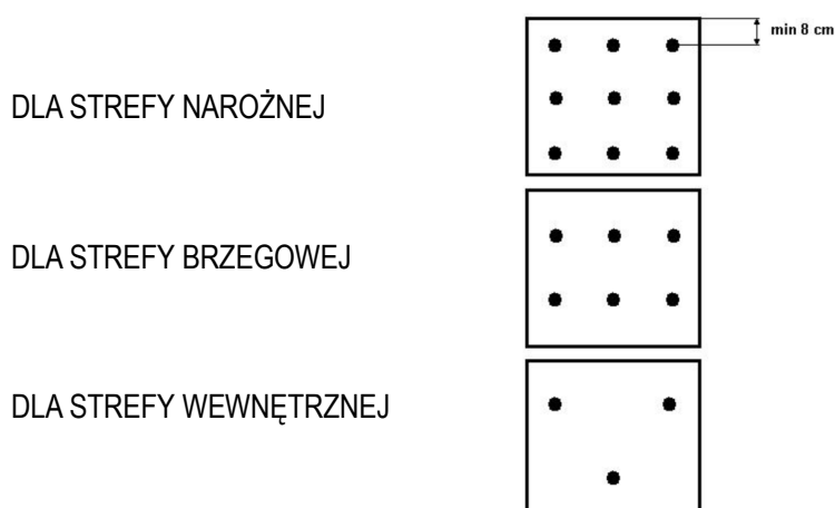
Rys 4. Zalecany rozkład łączników na płycie Styropapa
