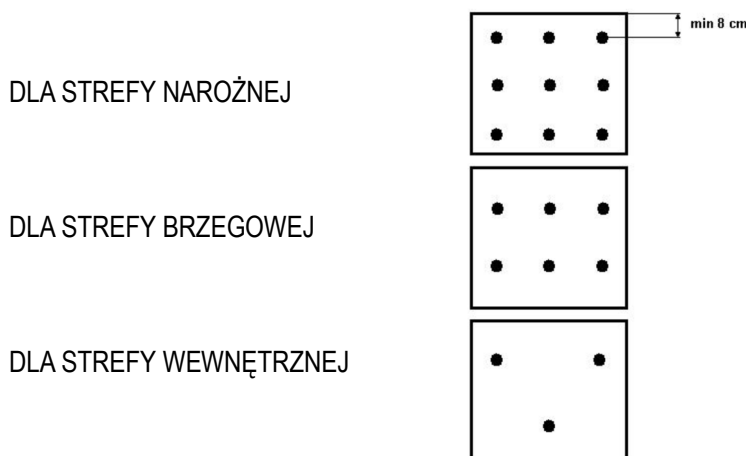
Rys 4. Zalecany rozkład łączników na płycie Styropapa
