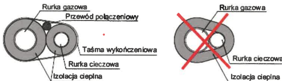
Rysunek 1 Sposób izolowania rurociągów
