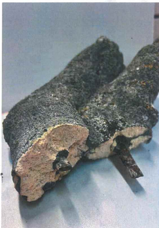
Krucyfiks Babiński. Stopy Chrystusa. Widoczne nawiercenia z umieszczonymi prętami stalowymi zalanymi mlekiem cementowym. fot. M. Pytka
