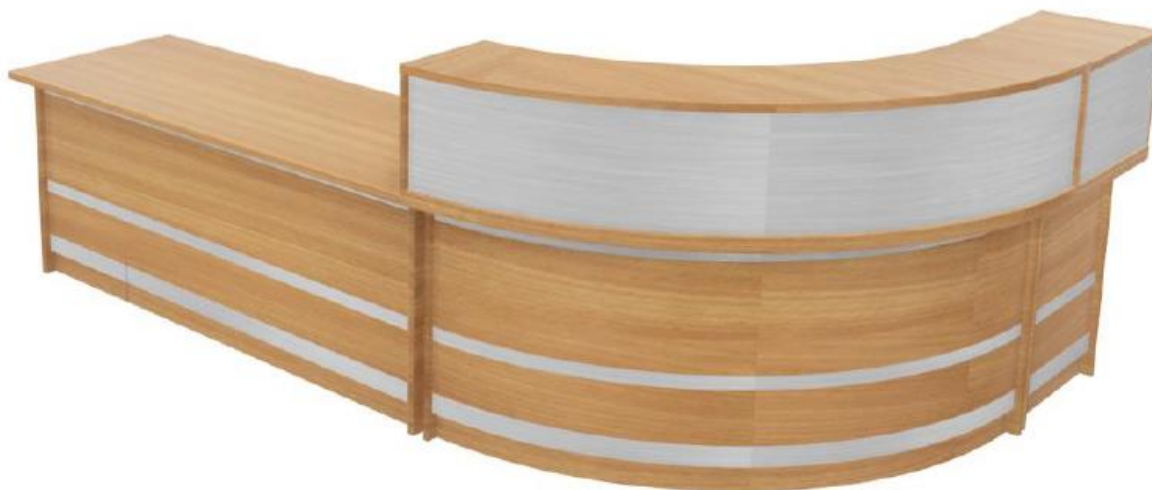
Rysunek 4 Szkic poglądowy lady od strony frontowej przedstawiający układ wkomponowania zdobień z płyty HPL
