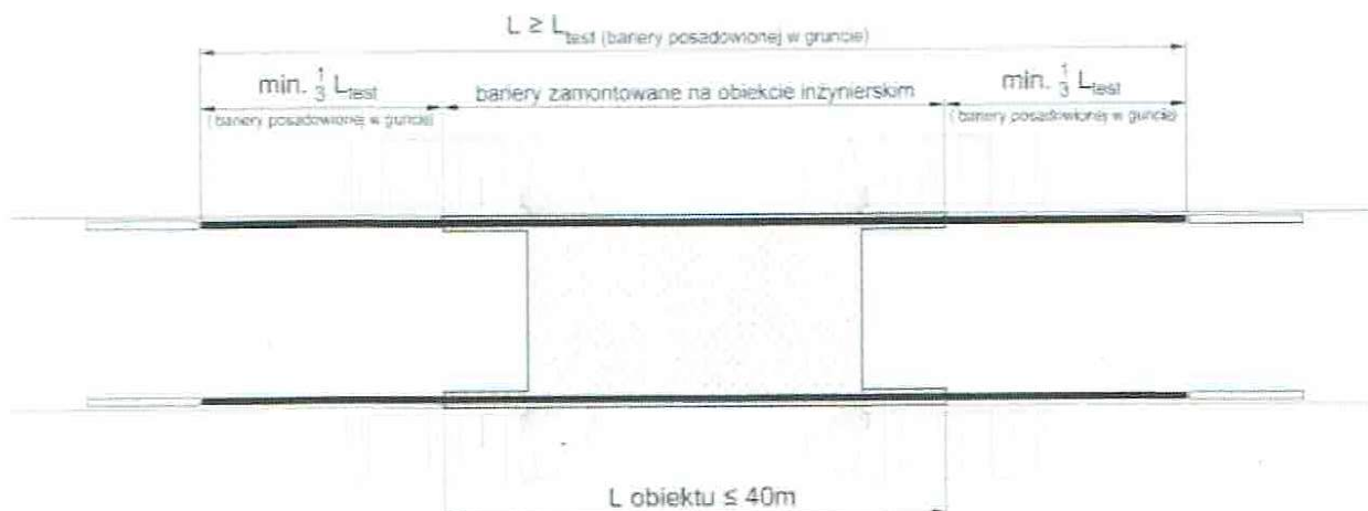
Rys. 14. Dopuszczalne rozwiązanie połączenia barier ochronnych na obiektach inżynierskich (w tym obiektach mostowych) o długości krótszej niż 40 m.
