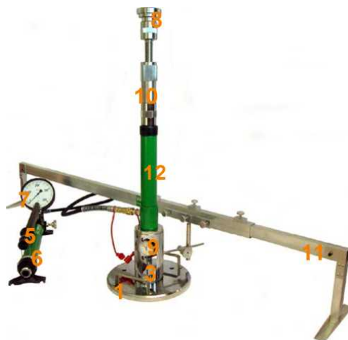
Rys. 1.2 Aparatura VSS z jednopunktowym pomiarem przemieszczenia płyty
