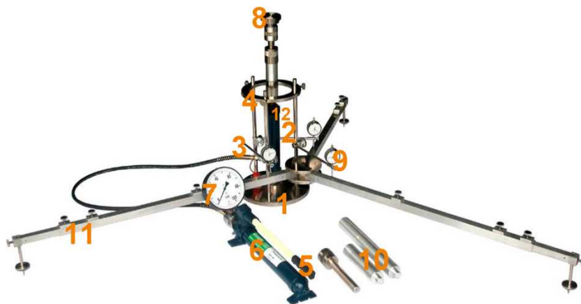
Rys. 1.1. Aparatura VSS z trzypunktowym pomiarem przemieszczenia płyty
