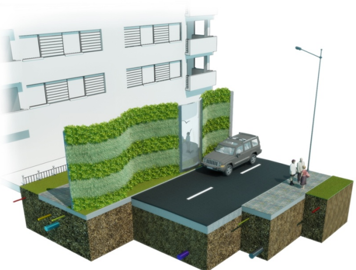
Ryc. 5. Roślinna ściana z zastosowaniem filcu
