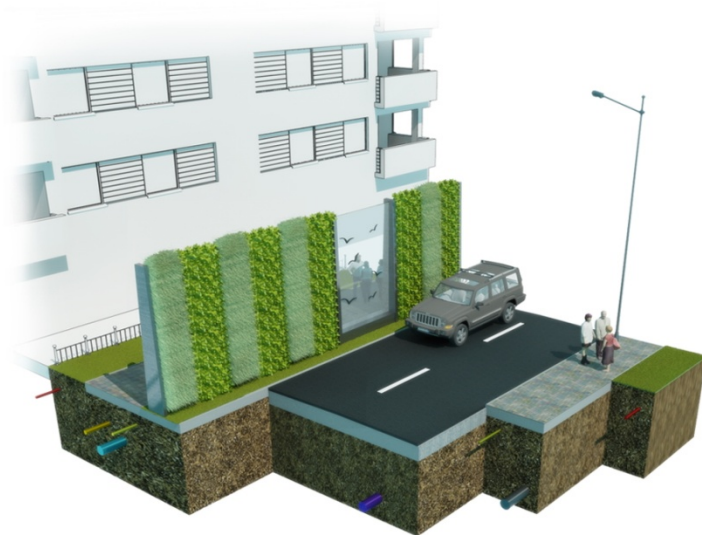
Ryc. 3. Roślinna ściana w formie gabionu
