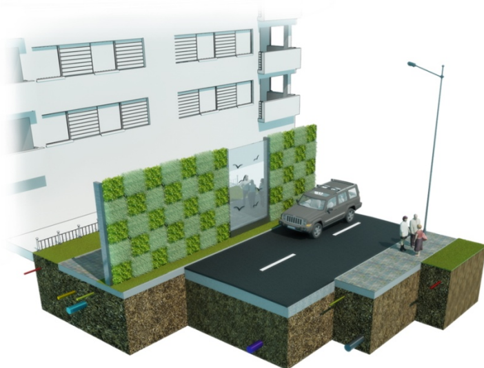
Ryc. 4. Roślinna ściana z zastosowaniem paneli roślinnych
