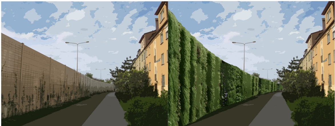
Ryc. 9. Roślinna ściana jako żywy ekran akustyczny
