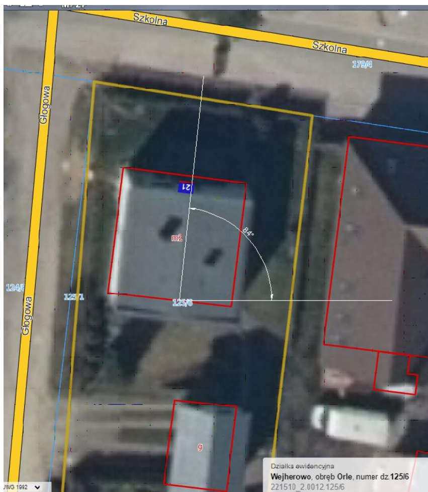
Rys. Wyznaczenie azymutu dla montażu paneli fotowoltaicznych
