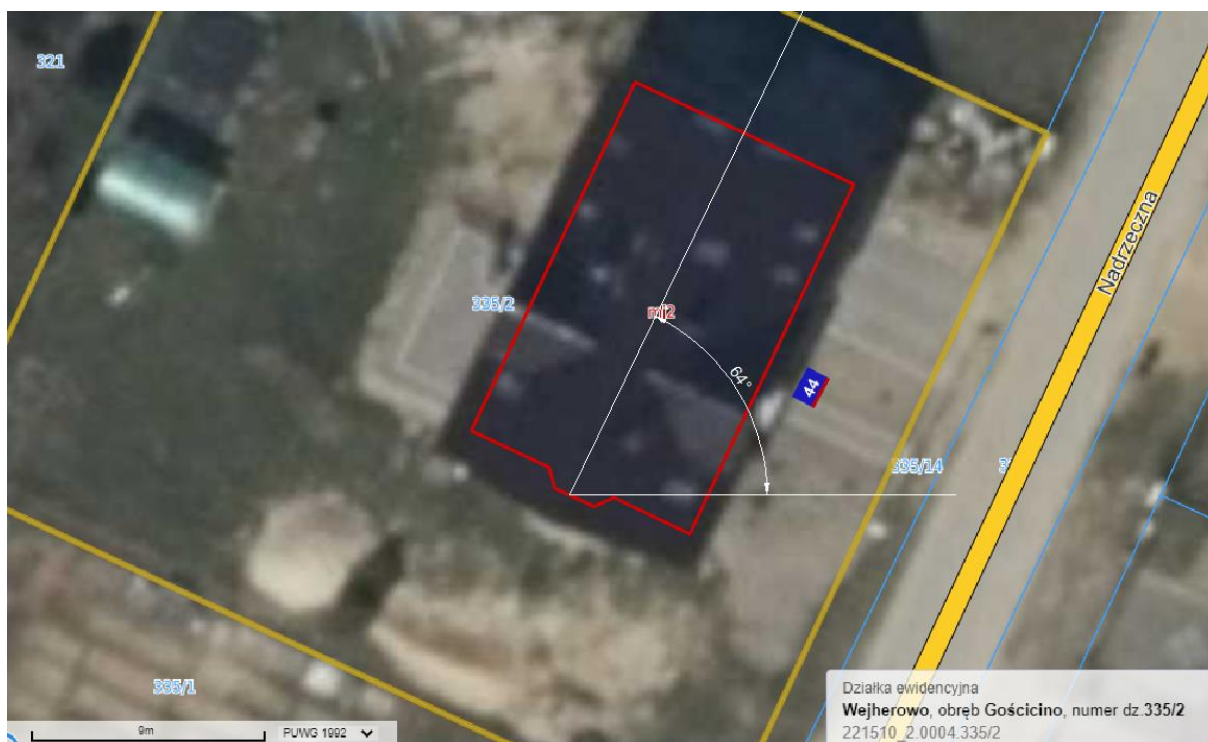
Rys. Wyznaczenie azymutu dla montażu paneli fotowoltaicznych
