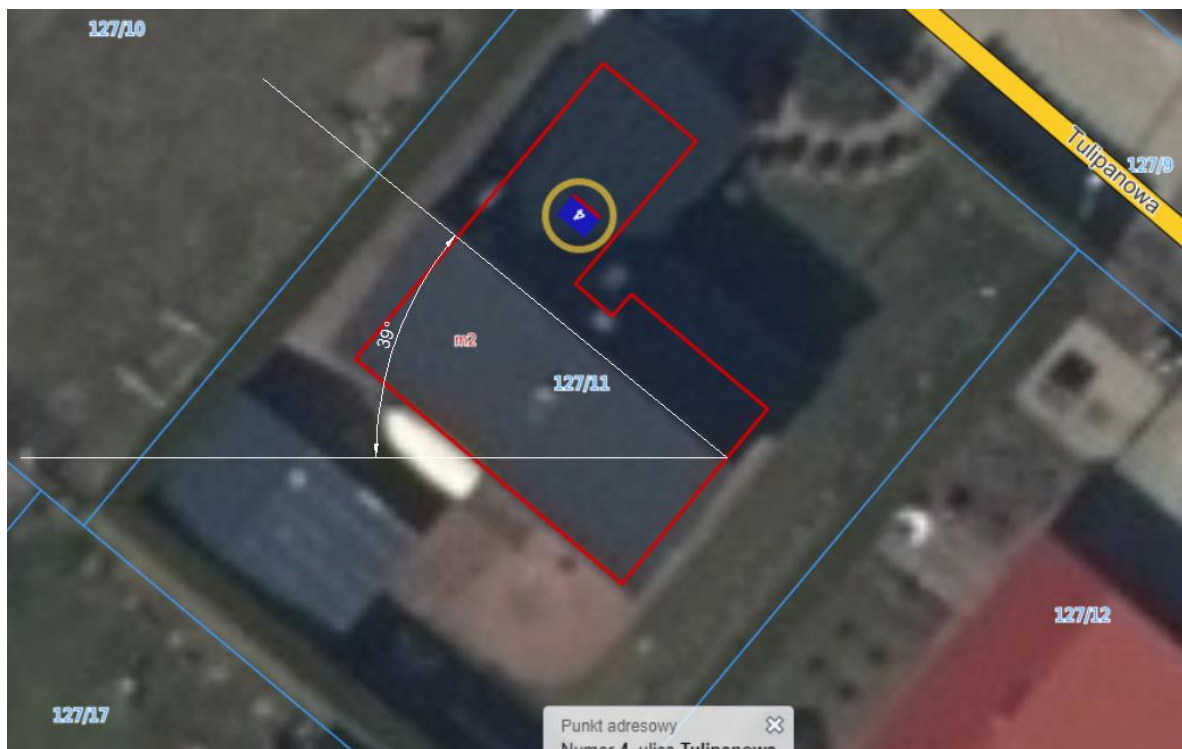
Rys. Wyznaczenie azymutu dla montażu paneli fotowoltaicznych
