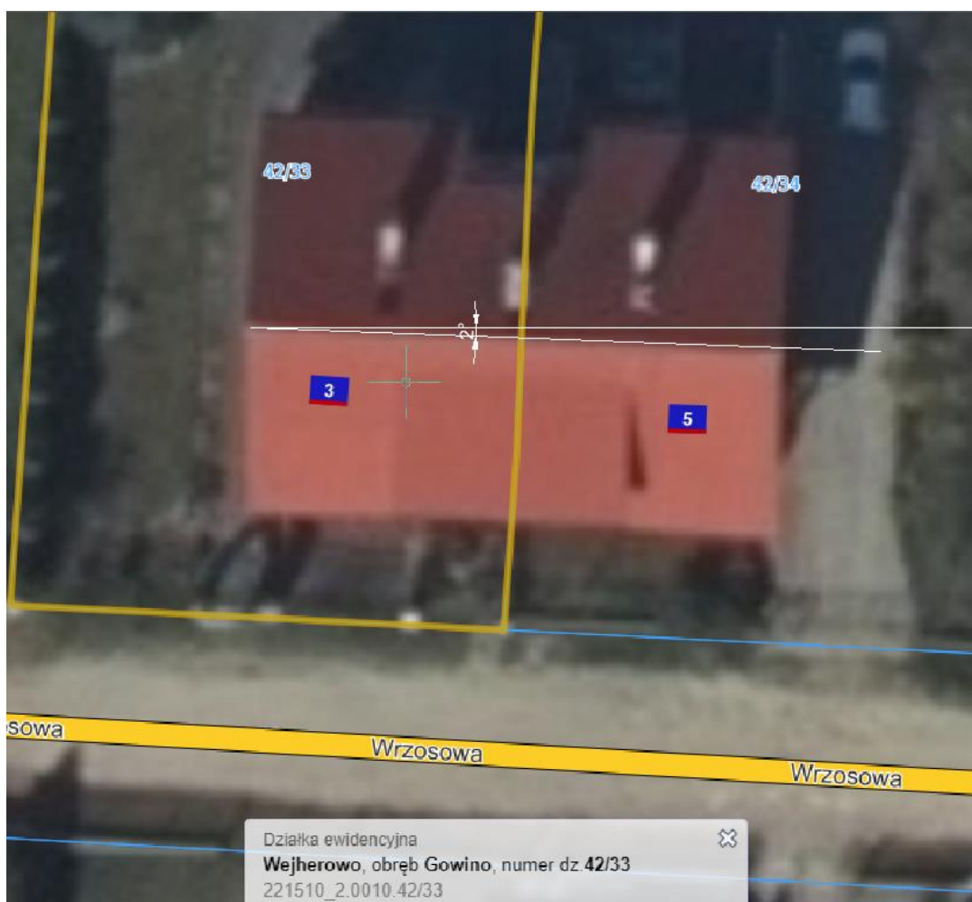
Rys. Wyznaczenie azymutu dla montażu paneli fotowoltaicznych
