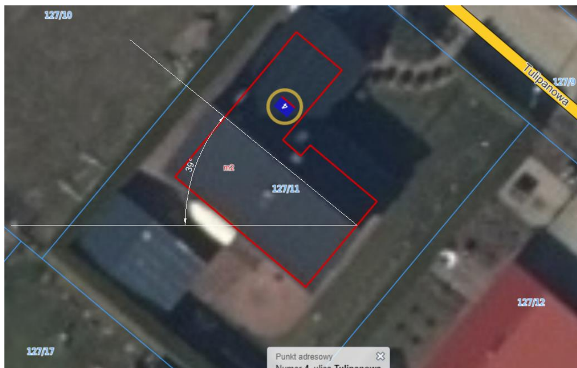
Rys. Wyznaczenie azymutu dla montażu paneli fotowoltaicznych
