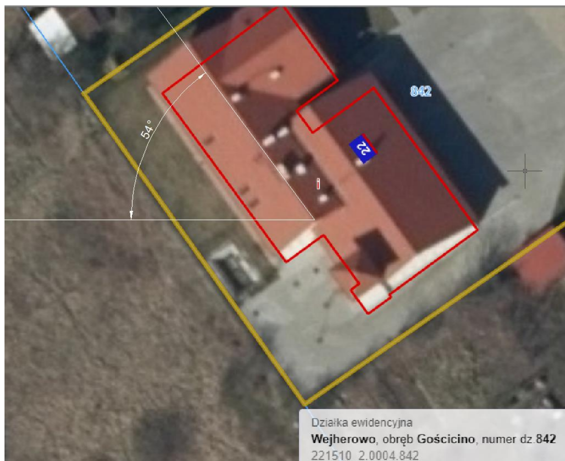
Rys. Wyznaczenie azymutu dla montażu paneli fotowoltaicznych
