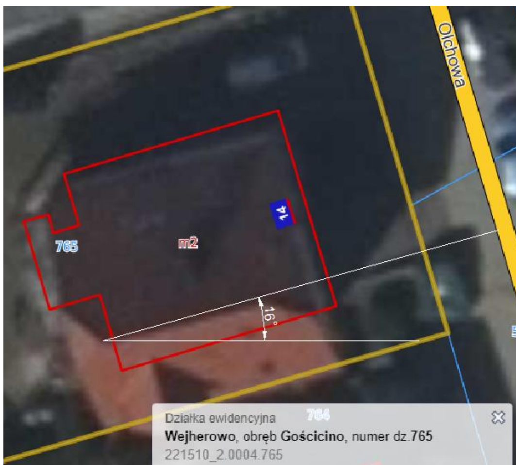
Rys. Wyznaczenie azymutu dla montażu paneli fotowoltaicznych
