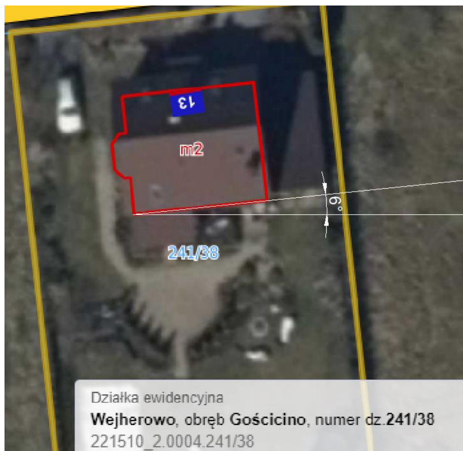
Rys. Wyznaczenie azymutu dla montażu paneli fotowoltaicznych
