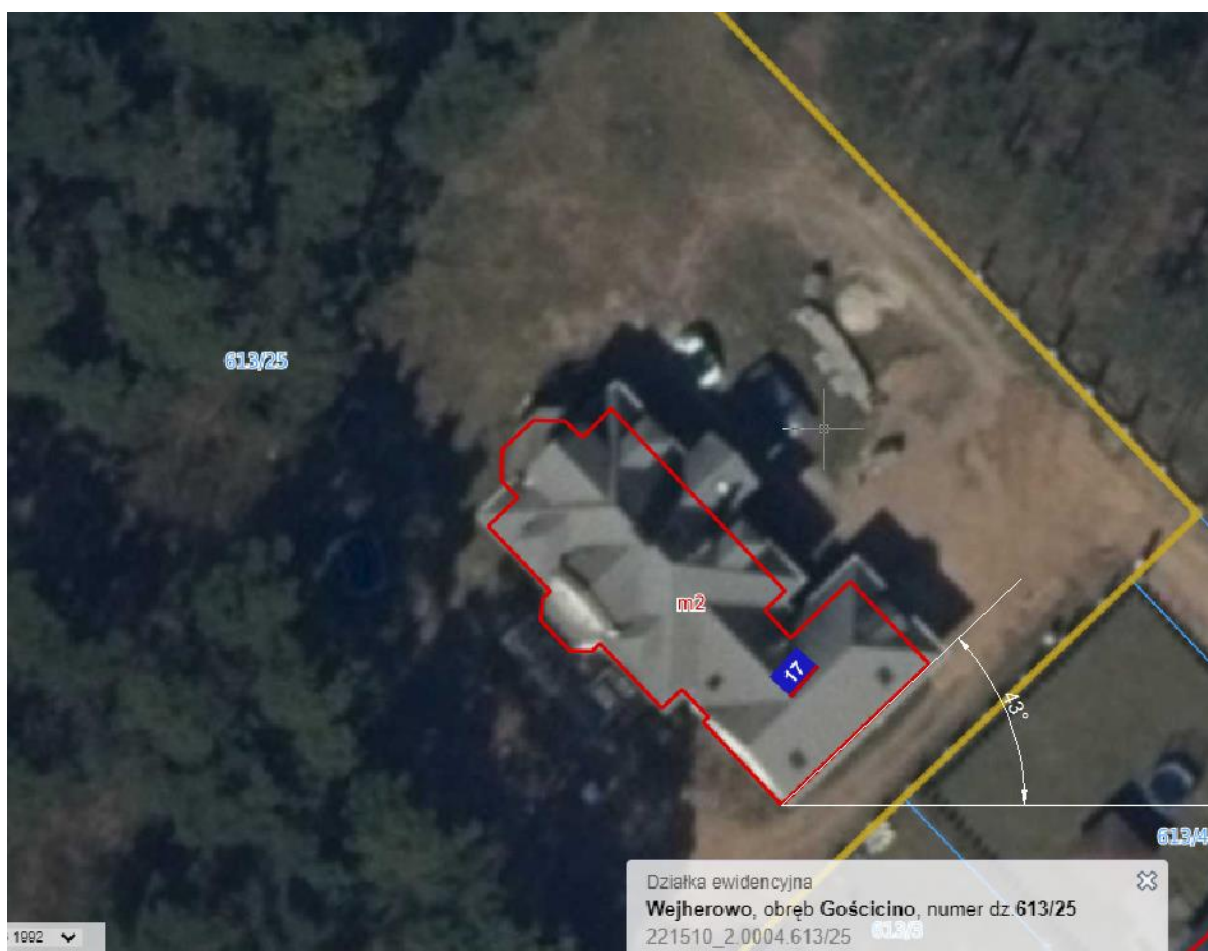
Rys. Wyznaczenie azymutu dla montażu paneli fotowoltaicznych
