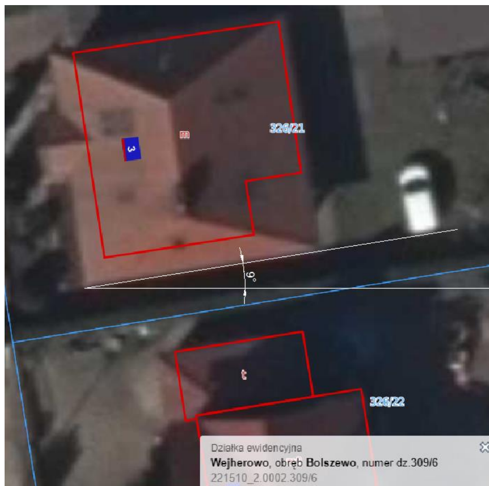
Rys. Wyznaczenie azymutu dla montażu paneli fotowoltaicznych
