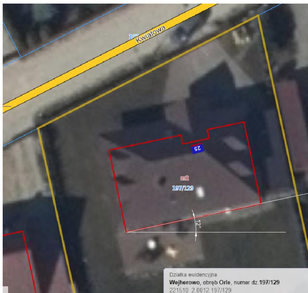
Rys. Wyznaczenie azymutu dla montażu paneli fotowoltaicznych
