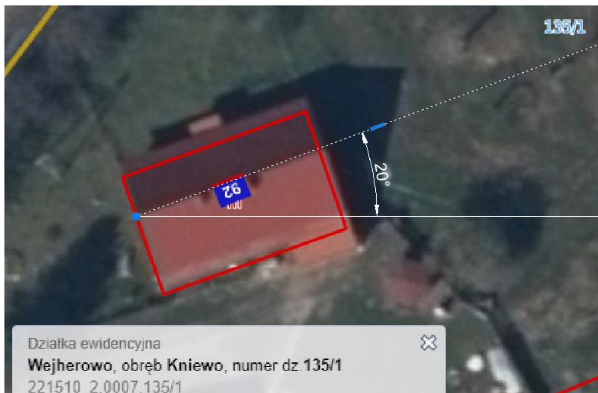
Rys. Wyznaczenie azymutu dla montażu paneli fotowoltaicznych
