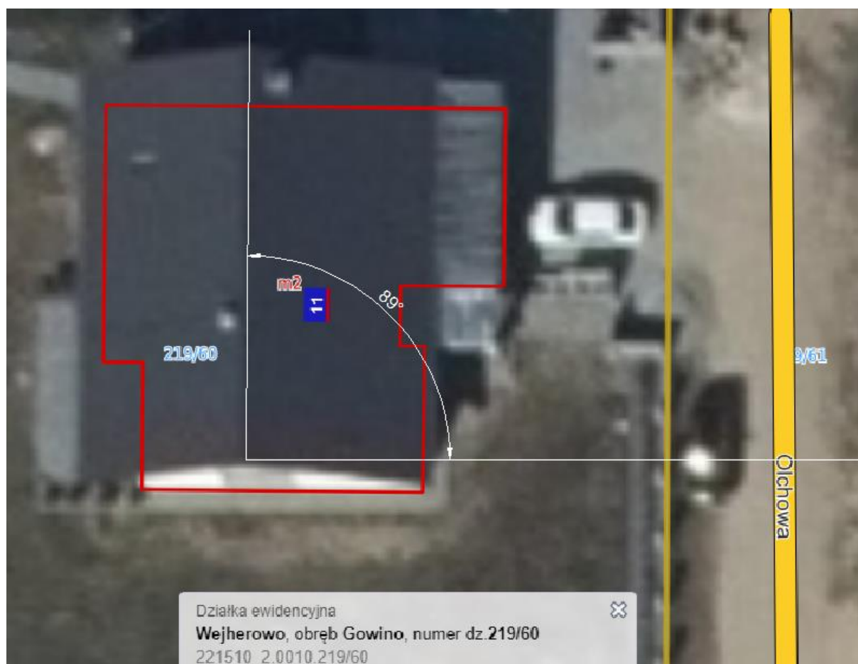
Rys. Wyznaczenie azymutu dla montażu paneli fotowoltaicznych
