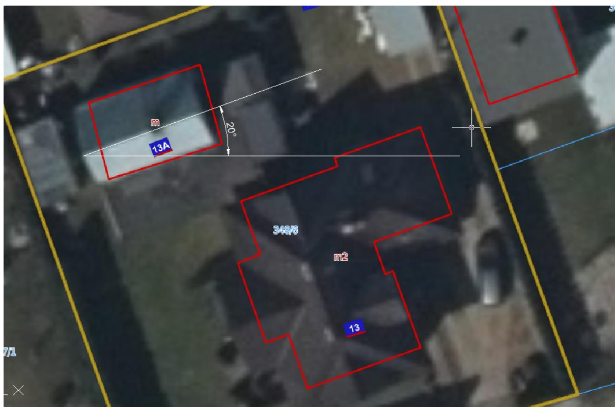
Rys. Wyznaczenie azymutu dla montażu paneli fotowoltaicznych
