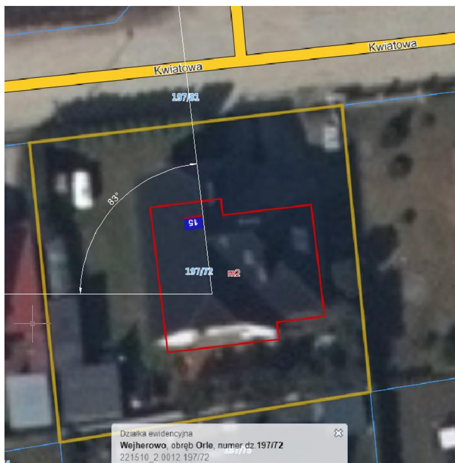
Rys. Wyznaczenie azymutu dla montażu paneli fotowoltaicznych
