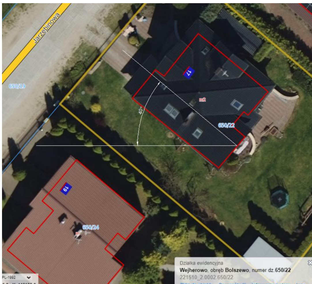
Rys. Wyznaczenie azymutu dla montażu paneli fotowoltaicznych
