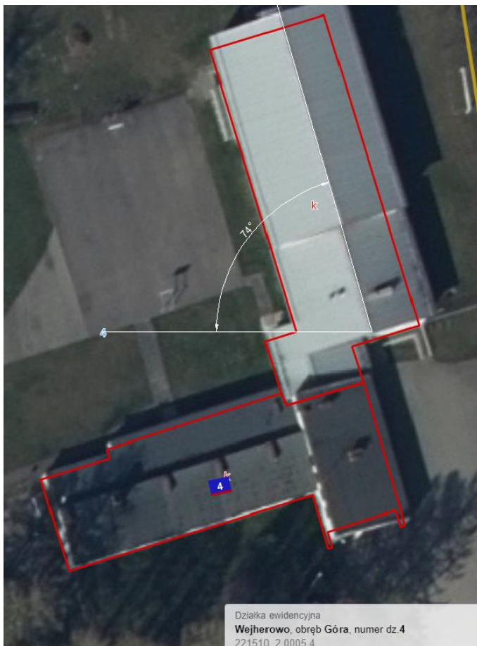
Rys. Wyznaczenie azymutu dla montażu paneli fotowoltaicznych
