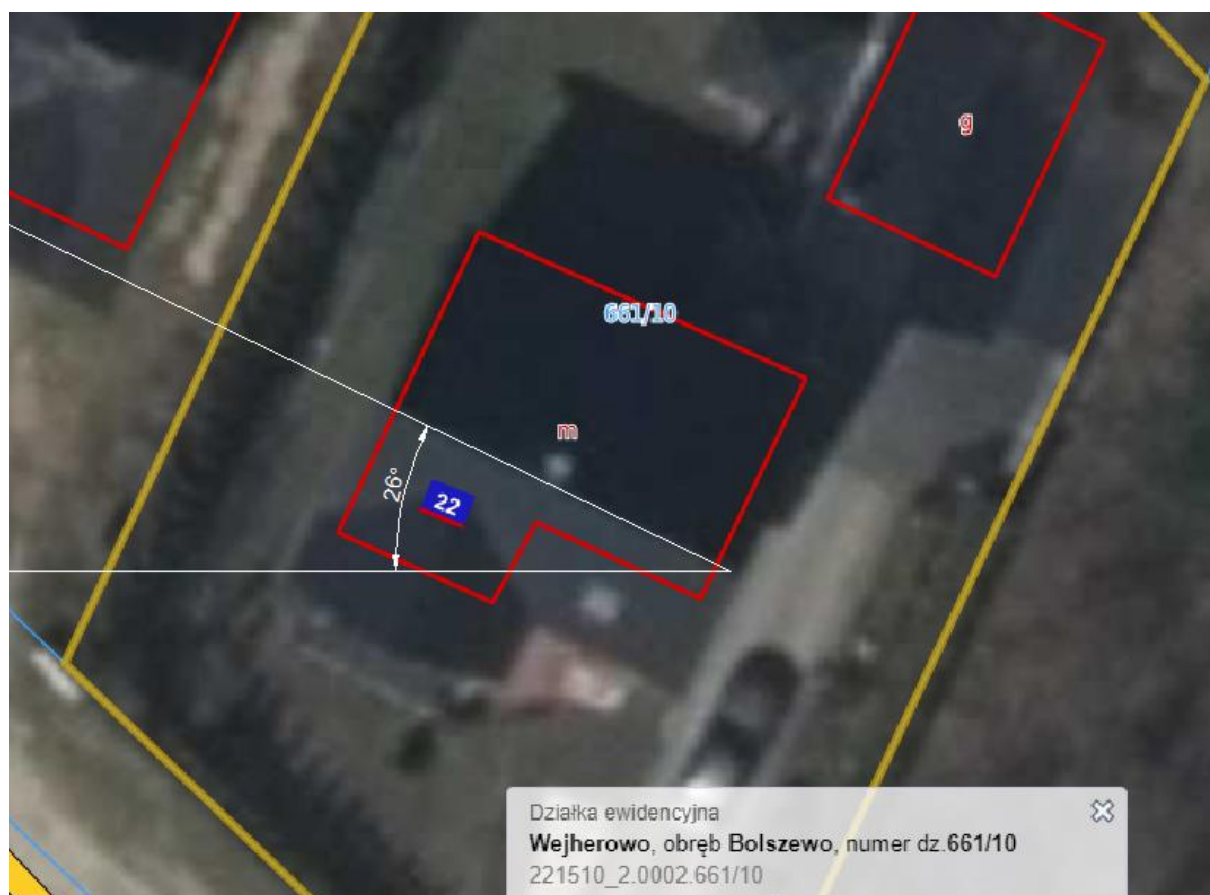
Rys. Wyznaczenie azymutu dla montażu paneli fotowoltaicznych
