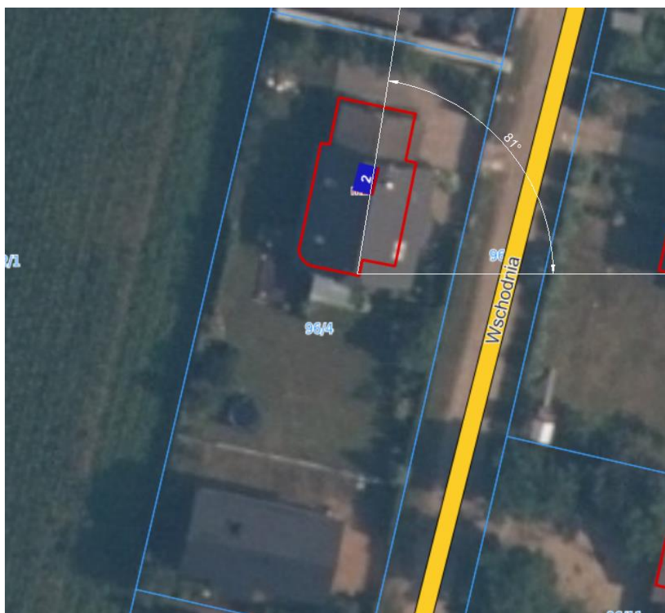
Rys. Wyznaczenie azymutu dla montażu paneli fotowoltaicznych
