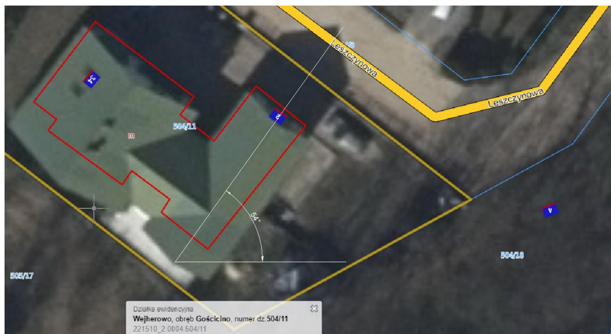
Rys. Wyznaczenie azymutu dla montażu paneli fotowoltaicznych
