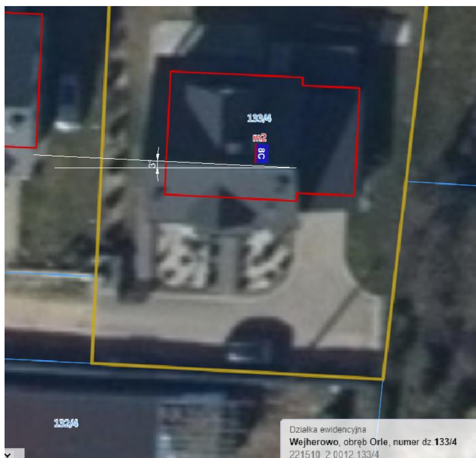
Rys. Wyznaczenie azymutu dla montażu paneli fotowoltaicznych
