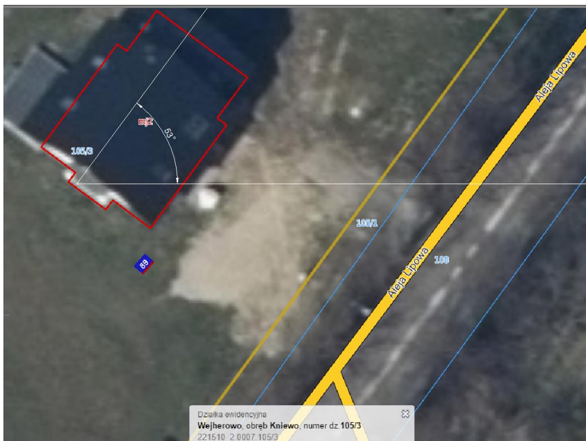
Rys. Wyznaczenie azymutu dla montażu paneli fotowoltaicznych
