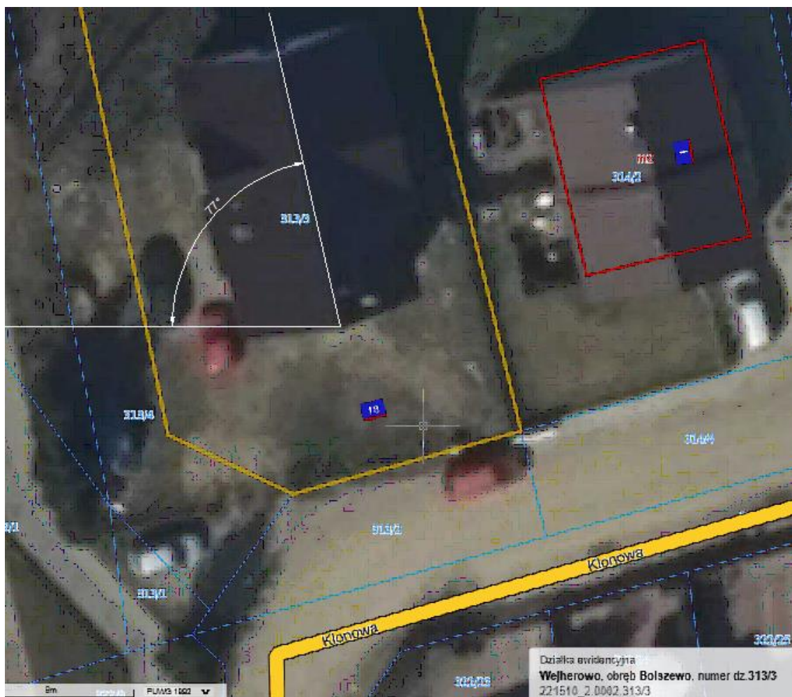
Rys. Wyznaczenie azymutu dla montażu paneli fotowoltaicznych
