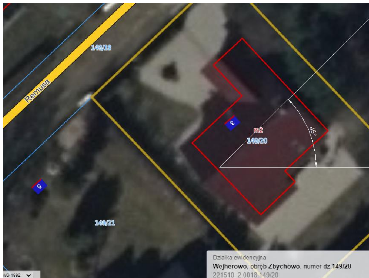
Rys. Wyznaczenie azymutu dla montażu paneli fotowoltaicznych
