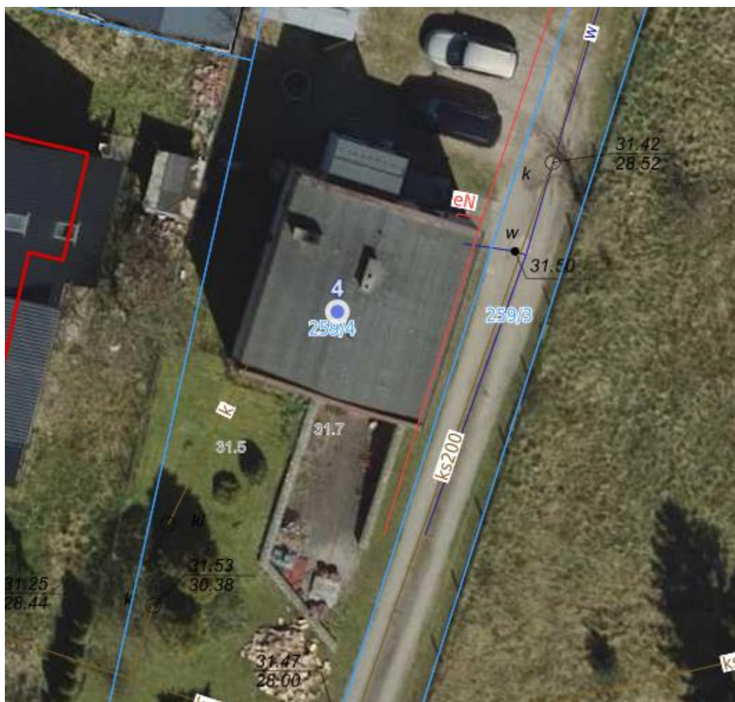
Rys. Wyznaczenie azymutu dla montażu paneli fotowoltaicznych
