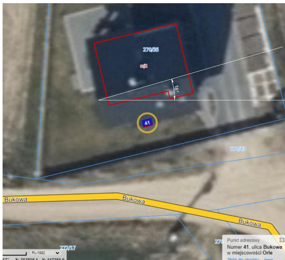
Rys. Wyznaczenie azymutu dla montażu paneli fotowoltaicznych
