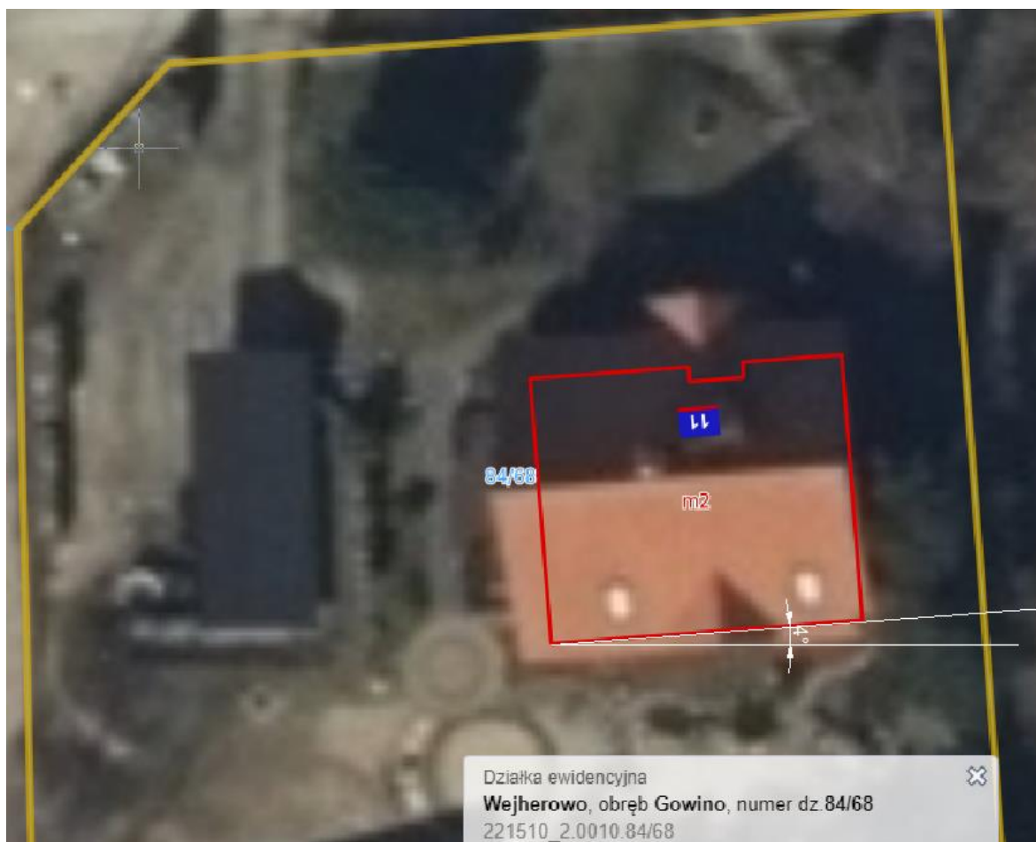
Rys. Wyznaczenie azymutu dla montażu paneli fotowoltaicznych
