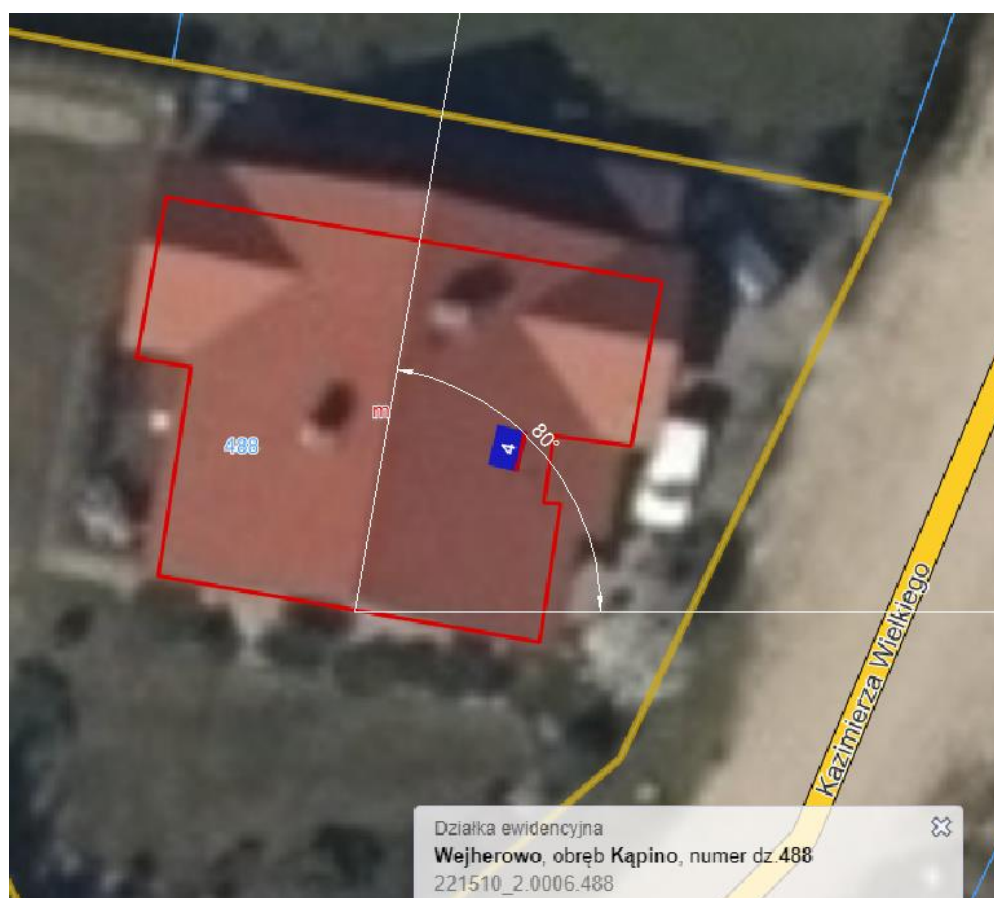
Rys. Wyznaczenie azymutu dla montażu paneli fotowoltaicznych
