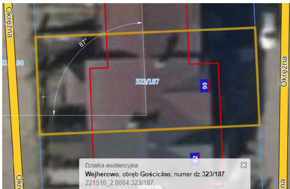
Rys. Wyznaczenie azymutu dla montażu paneli fotowoltaicznych
