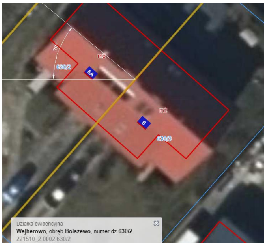
Rys. Wyznaczenie azymutu dla montażu paneli fotowoltaicznych
