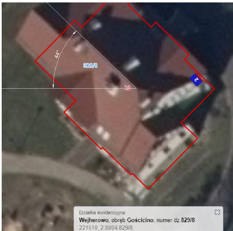
Rys. Wyznaczenie azymutu dla montażu paneli fotowoltaicznych
