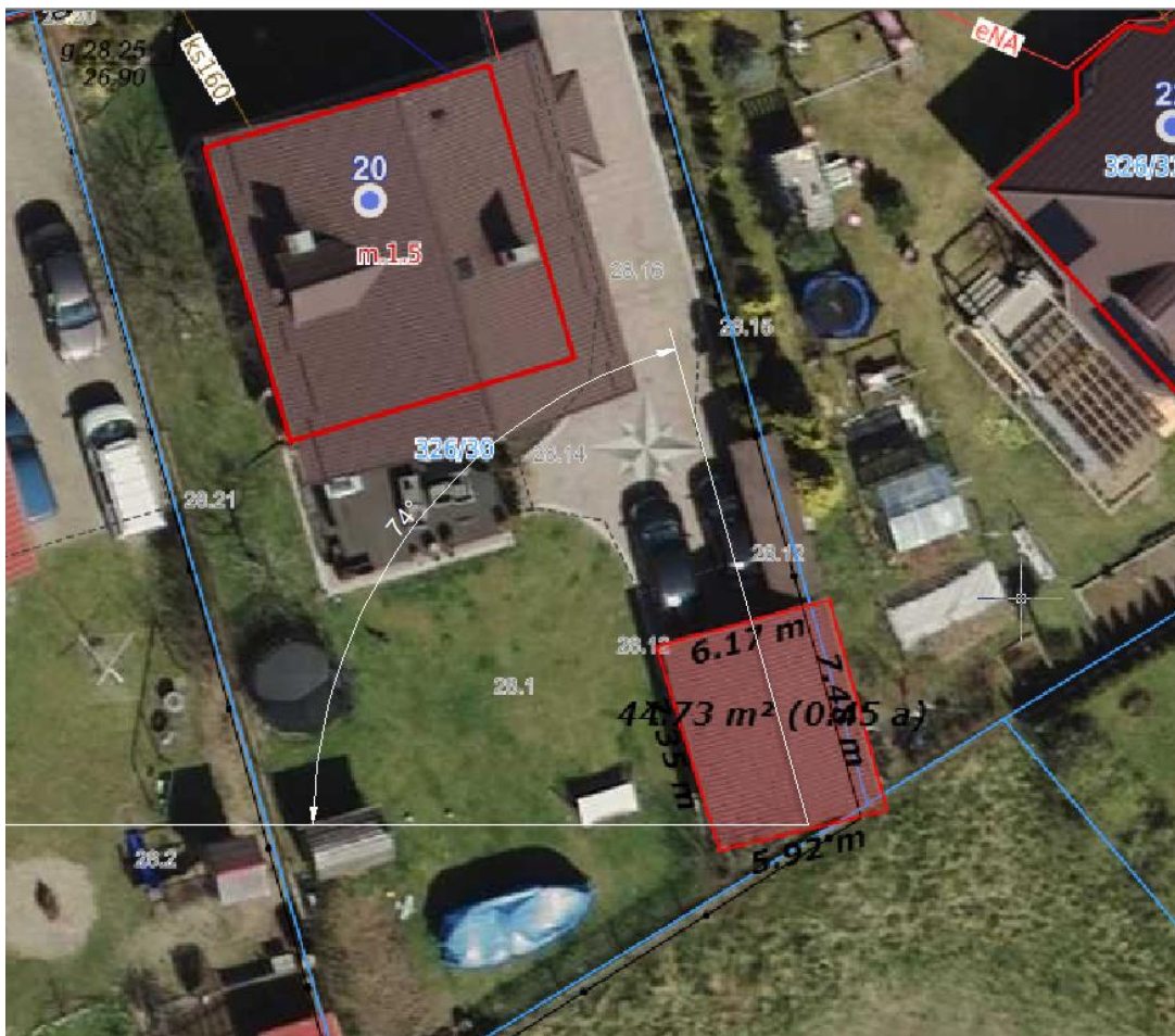
Rys. Wyznaczenie azymutu dla montażu paneli fotowoltaicznych
