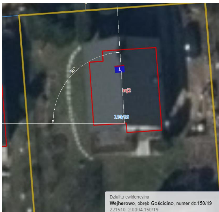
Rys. Wyznaczenie azymutu dla montażu paneli fotowoltaicznych
