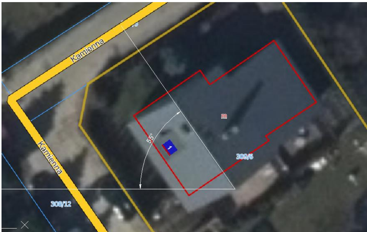
Rys. Wyznaczenie azymutu dla montażu paneli fotowoltaicznych
