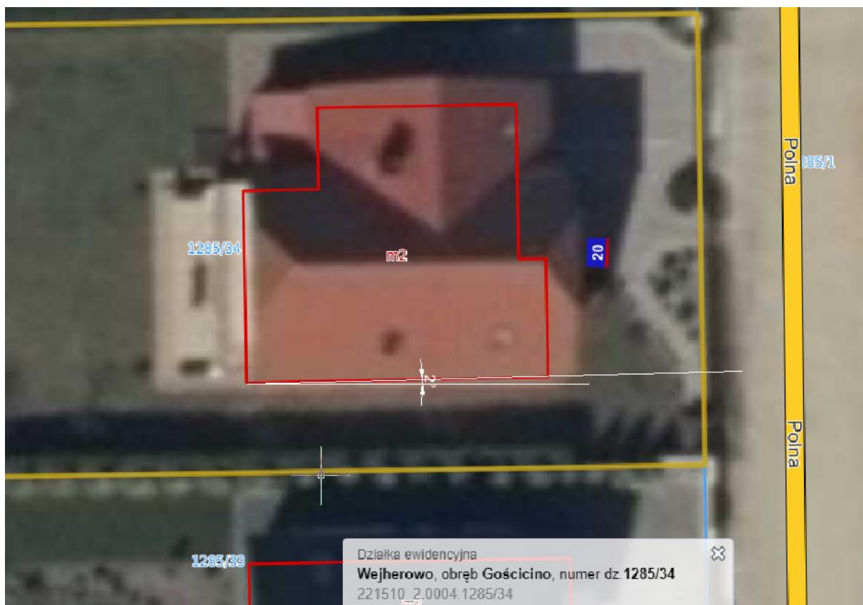
Rys. Wyznaczenie azymutu dla montażu paneli fotowoltaicznych
