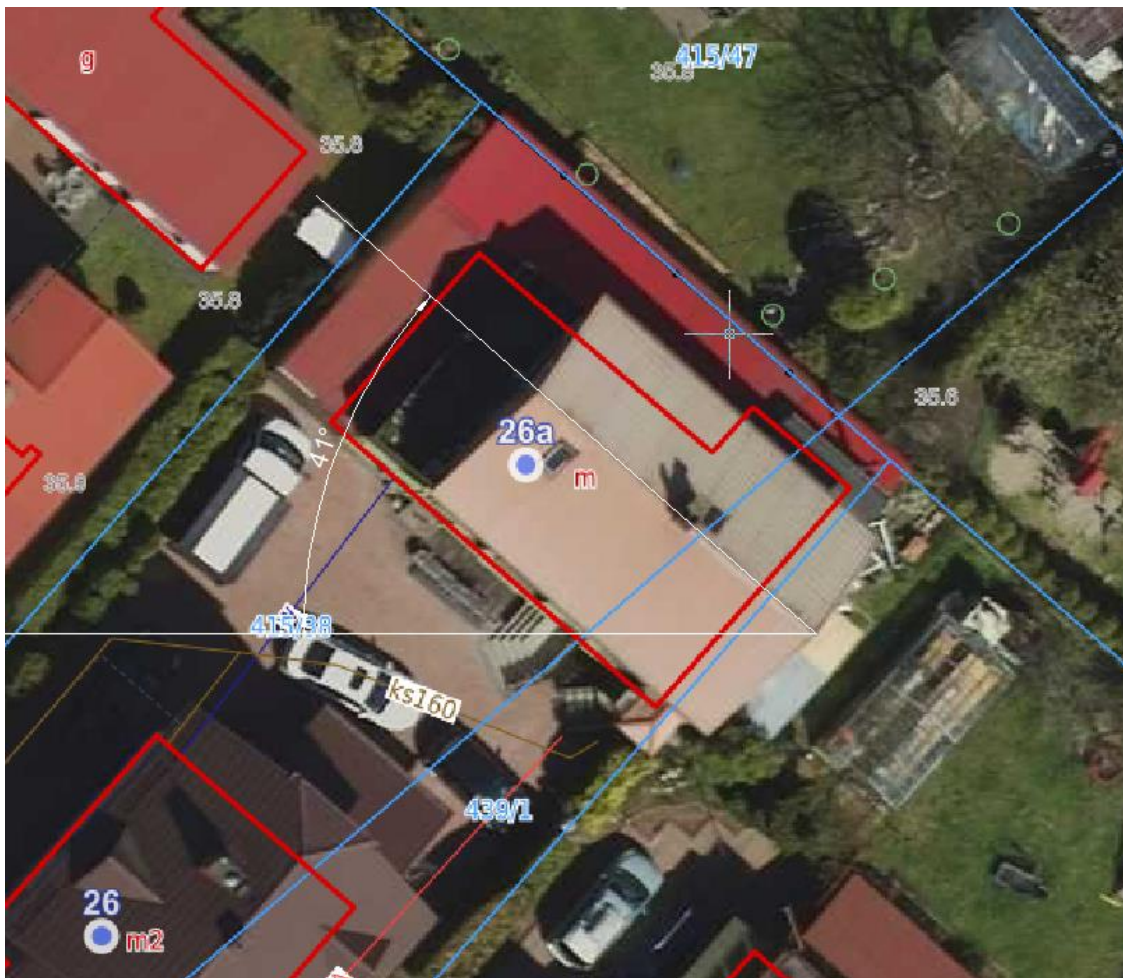
Rys. Wyznaczenie azymutu dla montażu paneli fotowoltaicznych
