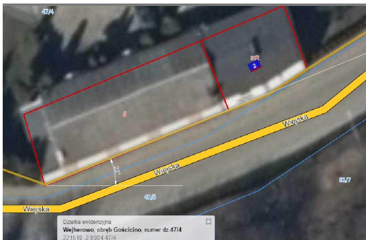
Rys. Wyznaczenie azymutu dla montażu paneli fotowoltaicznych
