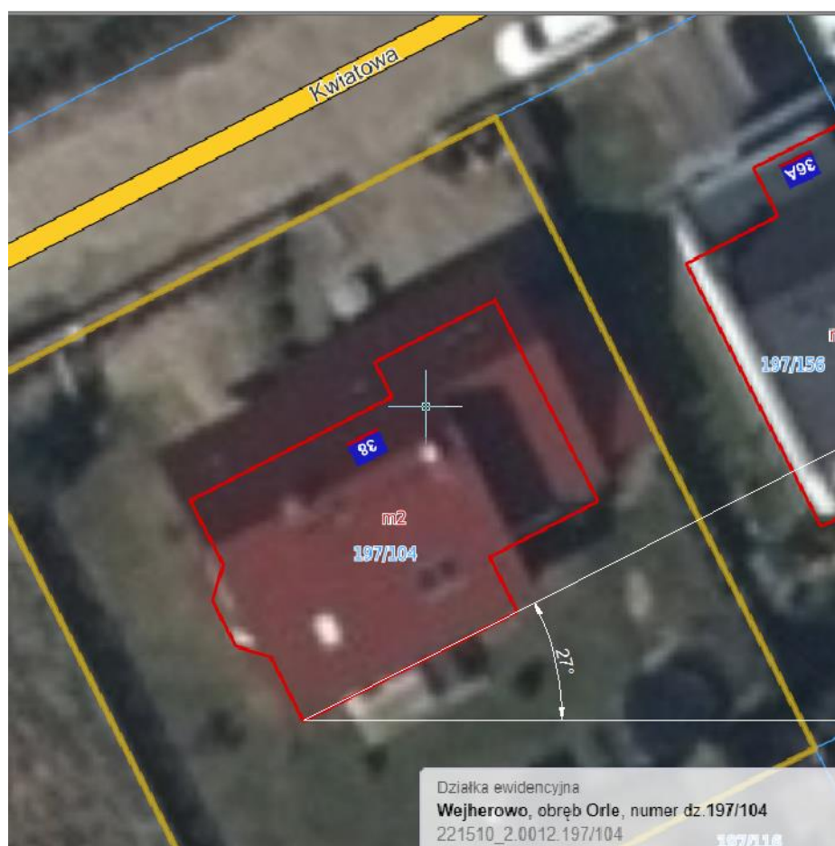
Rys. Wyznaczenie azymutu dla montażu paneli fotowoltaicznych
