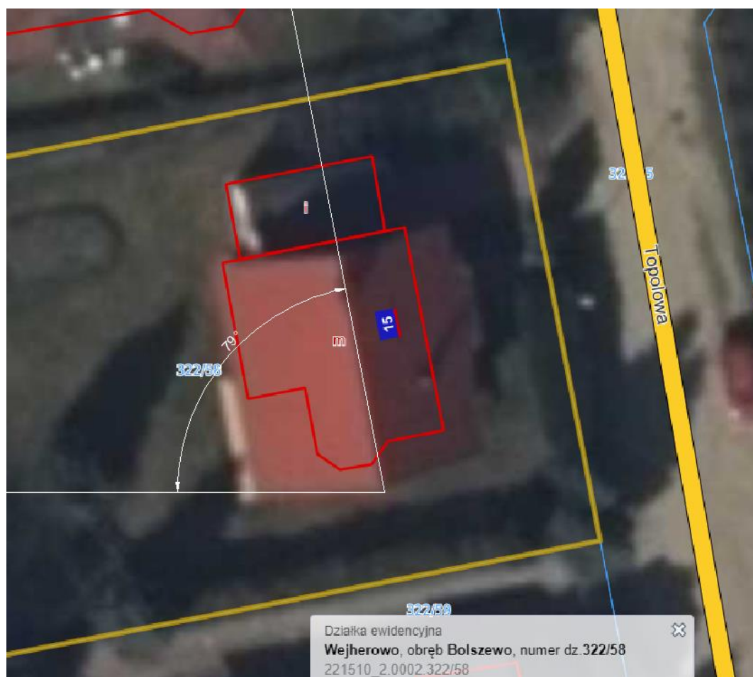
Rys. Wyznaczenie azymutu dla montażu paneli fotowoltaicznych
