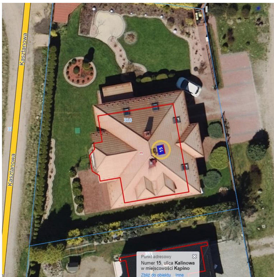
Rys. Wyznaczenie azymutu dla montażu paneli fotowoltaicznych
