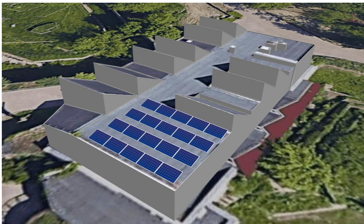
Rys.3 Wizualizacja rozmieszczenia modułów fotowoltaicznych na obiekcie nr 3.
