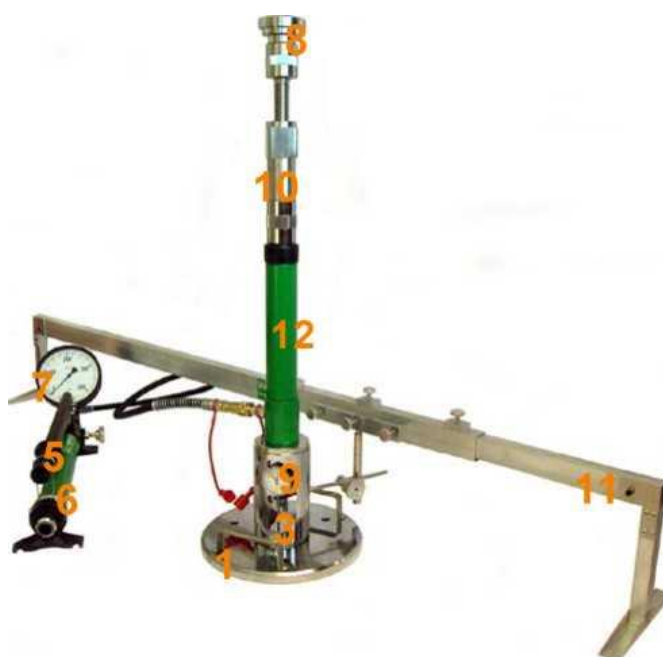
Rys. 1.2 Aparatura VSS z jednopunktowym pomiarem przemieszczenia płyty
