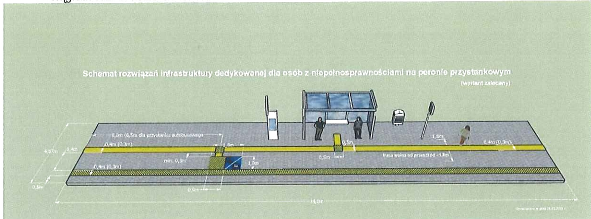
Rysunek 3 Schemat rozwiązań infrastruktury dedykowanej dla osób z niepełnosprawnościami na peronie przystankowym w wariancie zalecanym
