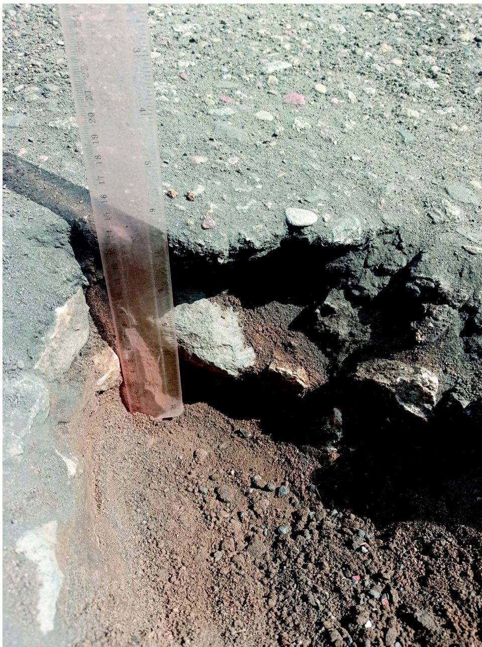
fot. 1. Odkrywka konstrukcji istniejącej nawierzchni drogowej.
